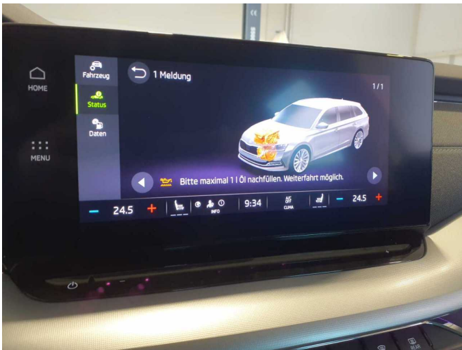
Damage 3: Instrument panel: Indicator light (Ölkontrolle, auf Undichtigkeiten prüfen) - on - Perform
