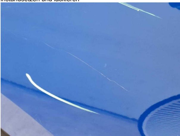
Beschädigung #13: Seitenwand links: Seitenwand - Kratzer - instandsetzen und lackieren
