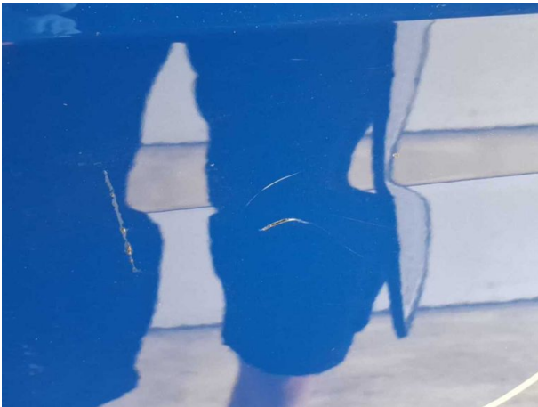
Beschädigung #12: Tür hinten links: Tür - verkratzt / verschürft - instandsetzen und lackieren
