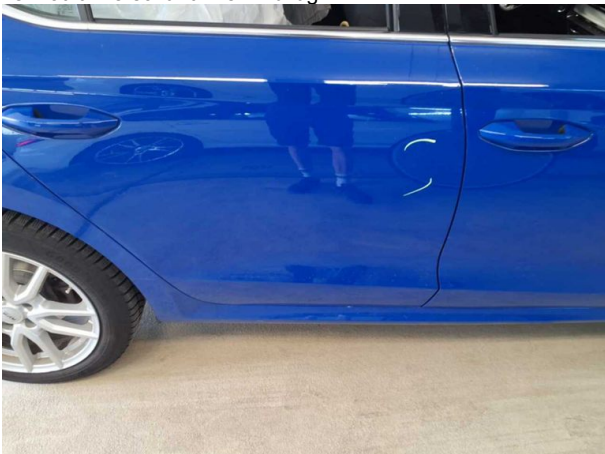
Beschädigung #5: Tür hinten rechts: Tür - verkratzt / verschürft - auslegen / polieren
