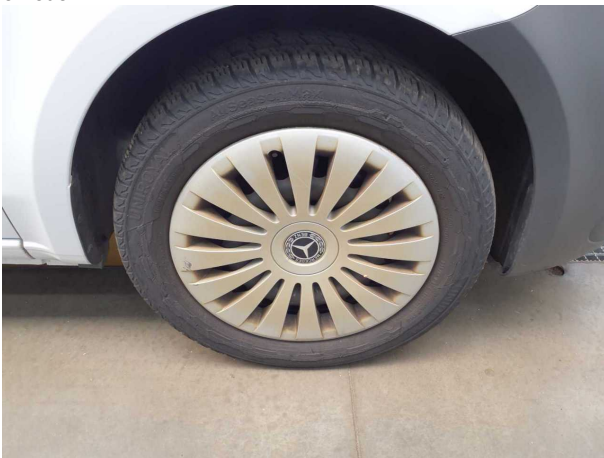
Beschädigung #3: Rad/Reifen: Radblende vorn rechts - Kratzer - erneuern
