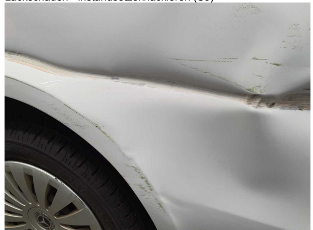
Beschädigung #24: Seitenwand rechts: Seitenwand - Delle / Lackschaden - instandsetzen/lackieren (S3)
