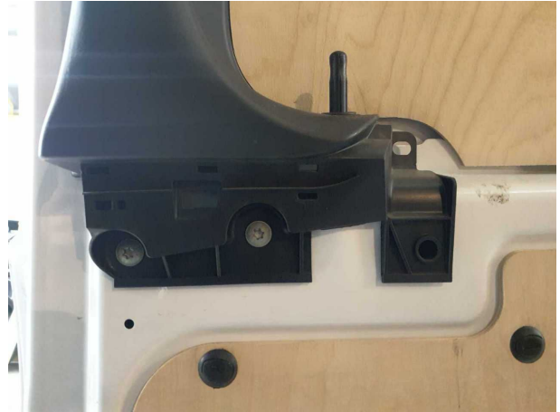
Beschädigung #8: Schiebetür rechts: Griff innen (Abdeckung) - fehlt - erneuern
