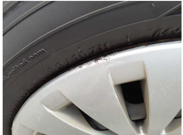
Beschädigung #2: Rad/Reifen: Radblende hinten rechts - Kratze... erneuern
