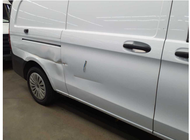
Beschädigung #22: Schiebetür rechts: Schiebetür - Delle / Lackschaden - instandsetzen/lackieren (S3)
