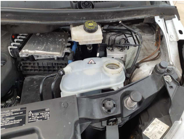
Beschädigung #14: Motorkühlung: Kühflüssigkeit (Öl in Kühflüssigkeit) - Befund festlegen - befunden ggf. instandsetzen
