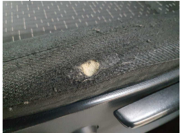
Beschädigung #16: Sitz vorn: Sitzpolster links - gebrochen / gerissen - erneuern
