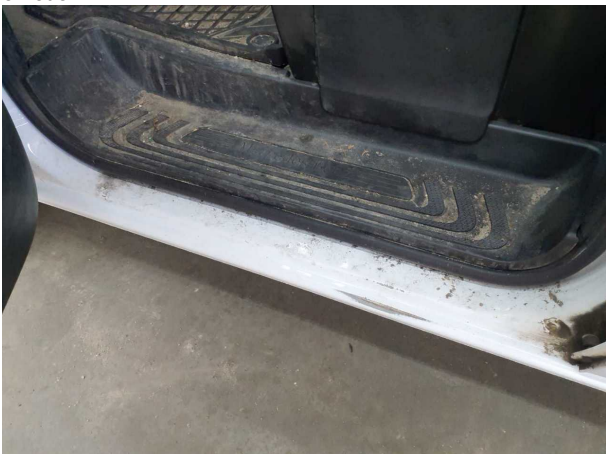
Beschädigung #17: Schweller links: Einstieg - Lackmangel - lackieren
