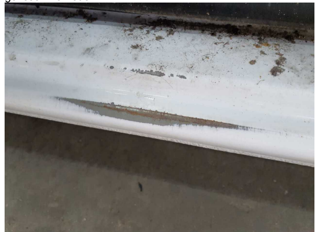
Beschädigung #17: Schweller links: Einstieg - Lackmangel - lackieren
