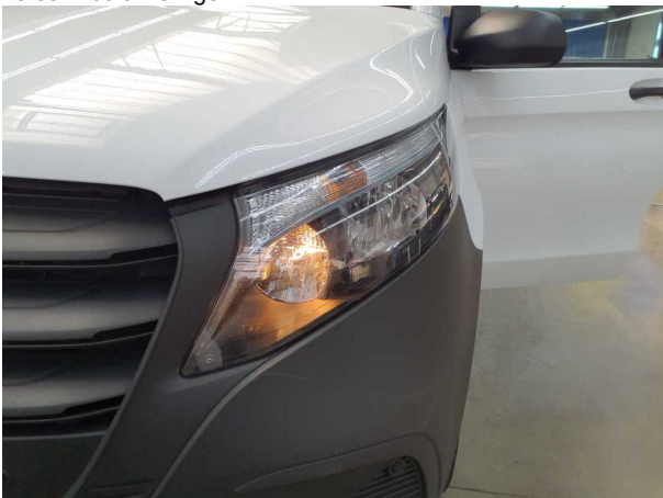
Beschädigung #7: Scheinwerfer: Scheinwerfer links (Abblendlicht) - ohne Funktion - erneuern
