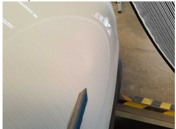
Beschädigung #11: Motorhaube: Motorhaube - Delle(n) - Smart Repair
