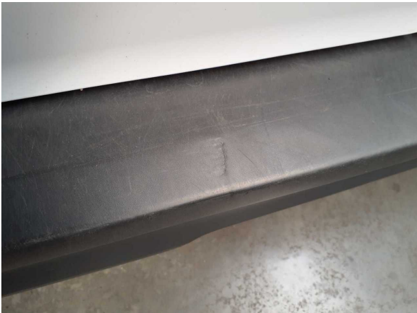
Beschädigung #20: Stossfänger hinten: Stossfänger hinten - Delle / Lackschaden - erneuern
