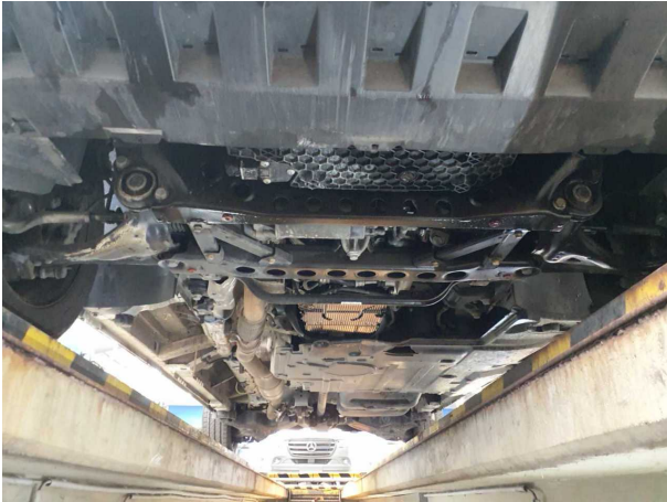
Beschädigung #12: Motor: Motorverkleidung unten - fehlt - erneuern
