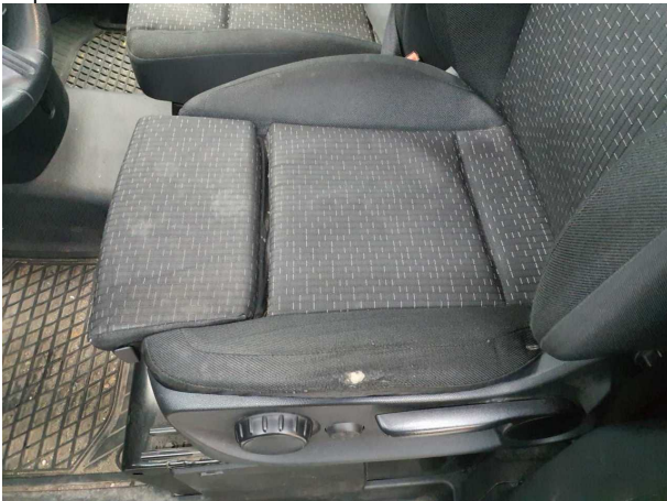
Beschädigung #16: Sitz vorn: Sitzpolster links - gebrochen / gerisse... erneuern
