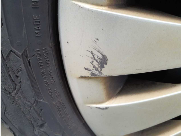
Beschädigung #3: Rad/Reifen: Radblende vorn rechts - Kratzer - erneuern
