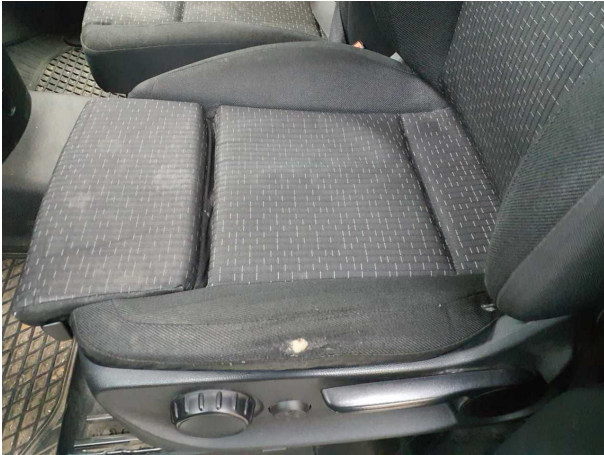
Beschädigung #18: Sitz vorn: Sitzbezug links - gebrochen / gerissen - erneuern
