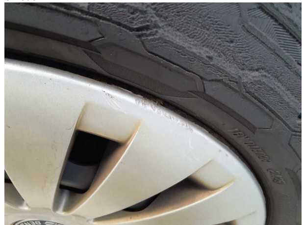
Beschädigung #3: Rad/Reifen: Radblende vorn rechts - Kratzer - erneuern
