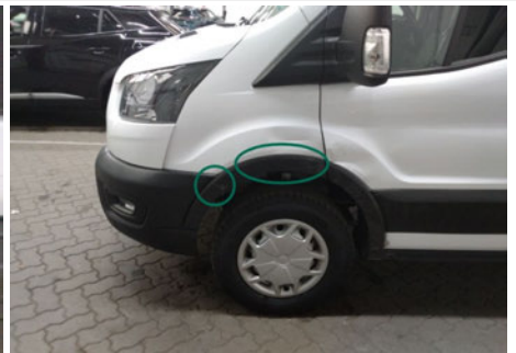
Kotflügelzierleiste / Vorne Links / Kratzer
