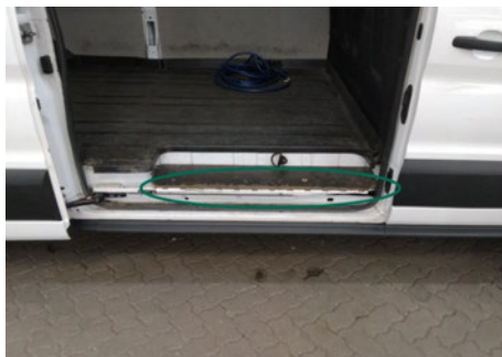
Holzboden / Rechts / Abgewetzt
