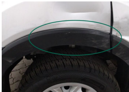
Kotflügelzierleiste / Vorne Links / Kratzer
