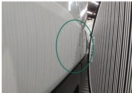
Heckklappe / Kofferraumtür / Unten Links / Gebrochen
