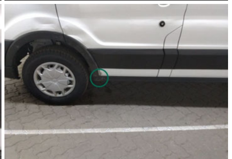
Schwellerabdeckung / Vorne Links / Gebrochen
