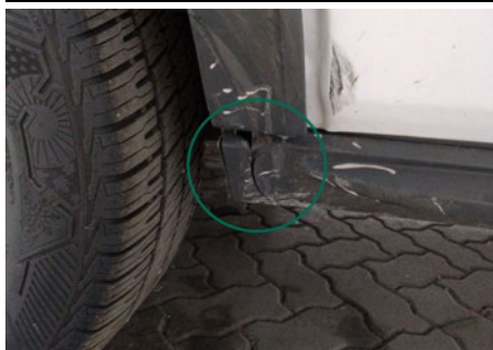
Schwellerabdeckung / Vorne Links / Gebrochen
