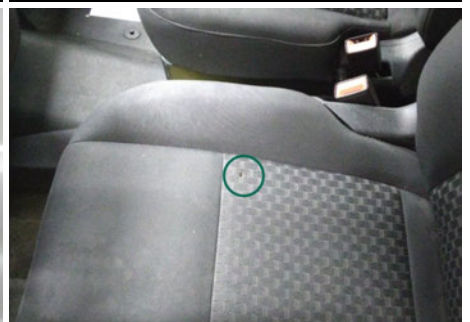
Polster Sitzfläche / Vorne Links / Brandstelle
