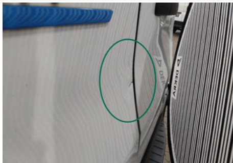
Heckklappe / Kofferraumtür / Unten Links / Gebrochen
