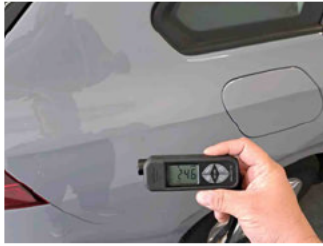
Lackstärke Seitenwand hinten rechts
