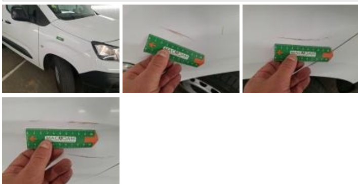
Porte de malle AR G, Bosse(s) et griffe(s), LI - Réparer et peindre (complet)
