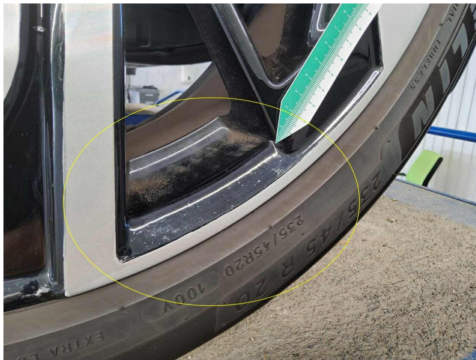
Bild 14 : LM Felge vorn rechts glanzgedreht teilweise repariert mit Restspuren
