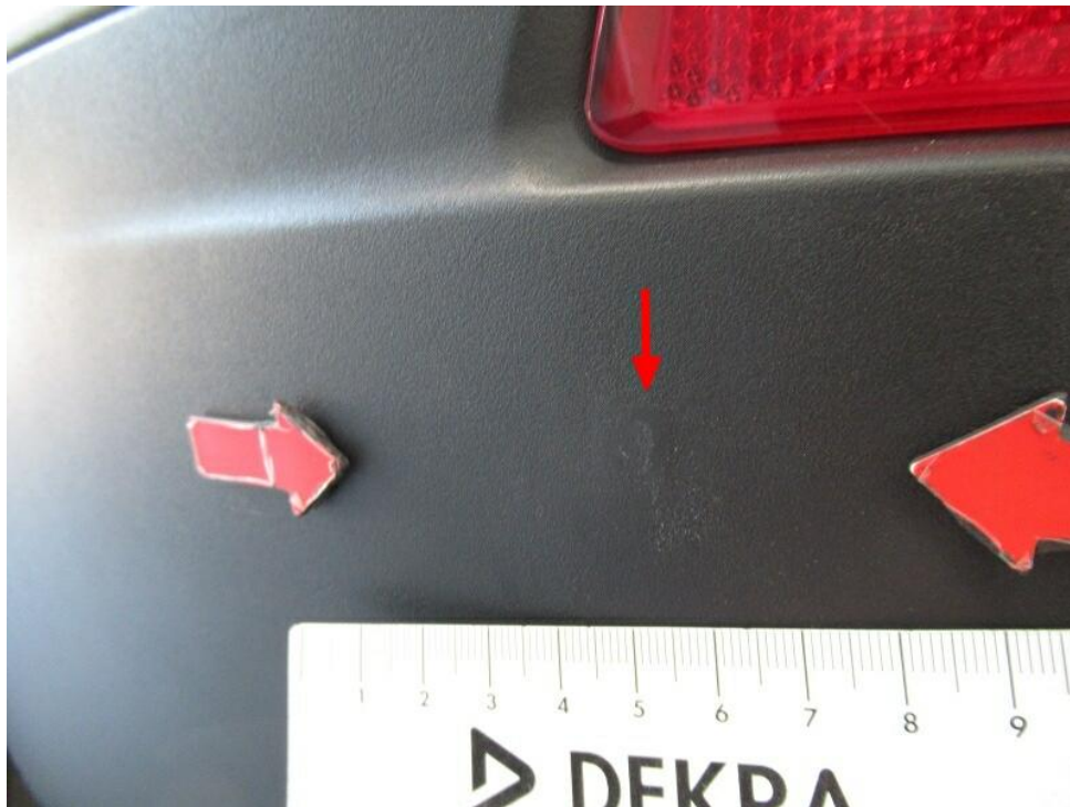
Bild 14 : Stoßfänger hinten Spoiler zerkratzt
