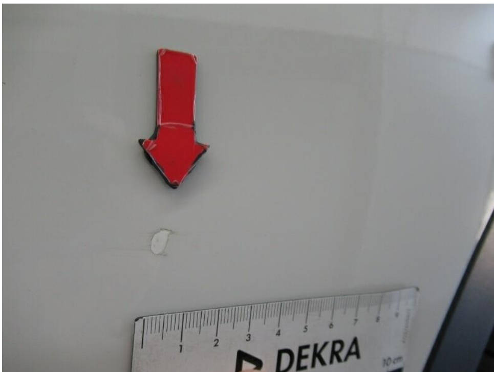
Bild 19 : Stoßfänger hinten Lackierung, zerkratzt, lackieren mit Lackaufbau
