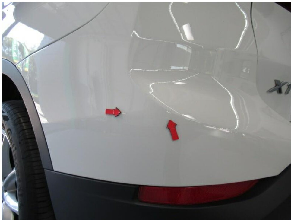
Bild 16 : Stoßfänger hinten Lackierung, zerkratzt, lackieren mit Lackaufbau
