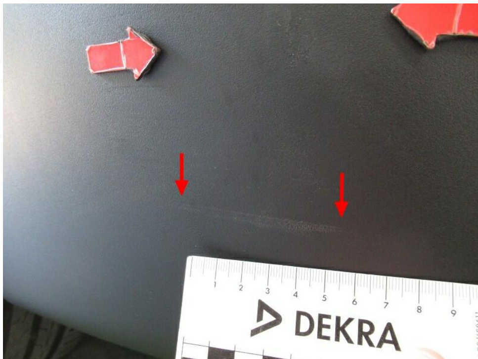
Bild 15 : Stoßfänger hinten Spoiler zerkratzt
