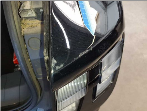
Beschädigung #5: Seitenwand rechts: Seitenwand - Kratzer - instandsetzen und lackieren
