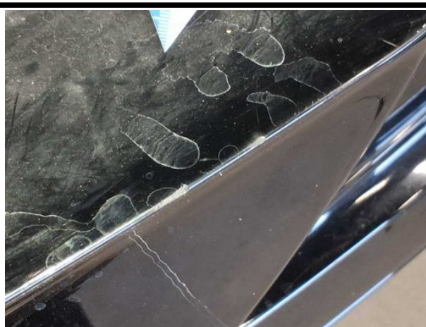
Beschädigung #4: Stossfänger hinten: Stossfänger hinten - Kratzer - instandsetzen und lackieren
