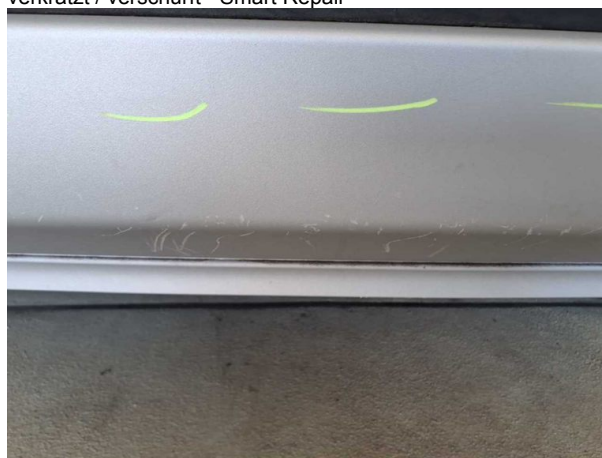
Beschädigung #6: Stossfänger hinten: Spoiler - verkratzt / verschürft - erneuern
