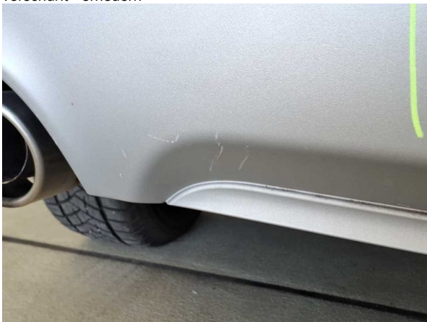
Beschädigung #6: Stossfänger hinten: Spoiler - verkratzt / verschürft - erneuern
