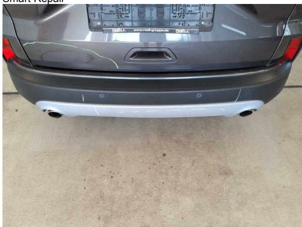
Beschädigung #6: Stossfänger hinten: Spoiler - verkratzt / verschürft - erneuern
