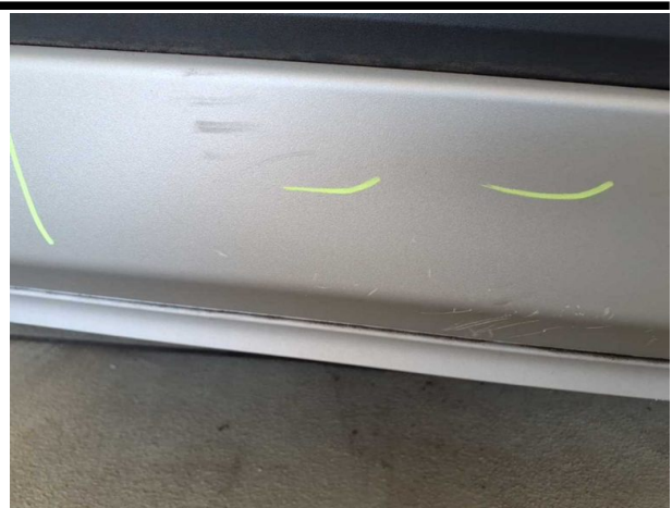
Beschädigung #6: Stossfänger hinten: Spoiler - verkratzt / verschürft - erneuern
