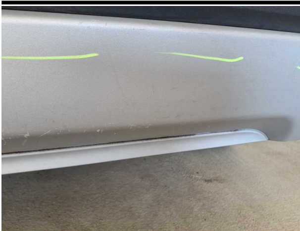
Beschädigung #6: Stossfänger hinten: Spoiler - verkratzt / verschürft - erneuern
