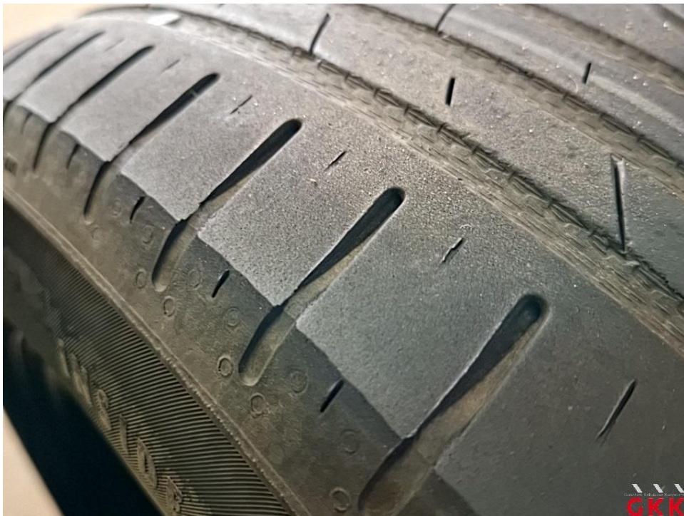
Bild 20 einseitig abgefahren Reifen, 2 x beiliegend, beschädigt, ersetzen
