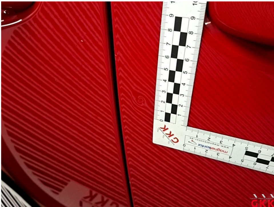
Bild 18 Tür vorne rechts, beschädigt, kalt drücken
