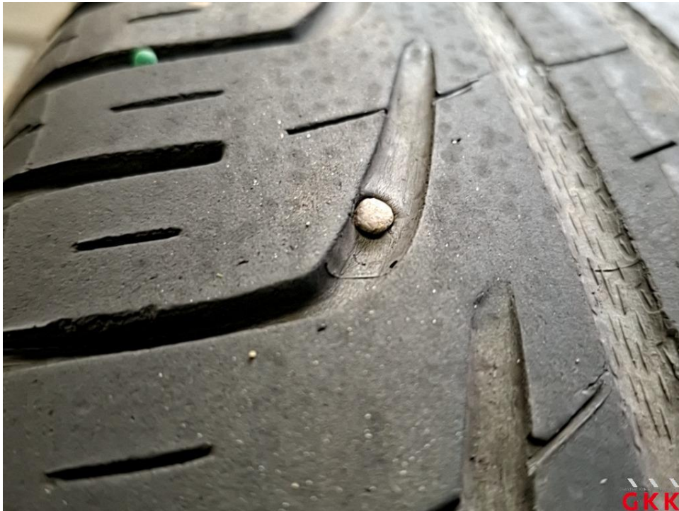
Bild 21 Nagelloch Reifen, 2 x beiliegend, beschädigt, ersetzen
