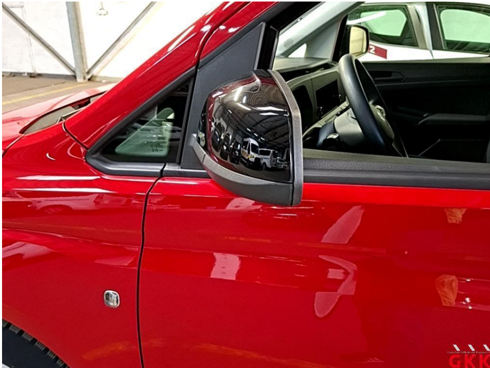
Bild 15 Spiegelgehäuse links, Kappe -lackiert-, verkratzt, lackieren
