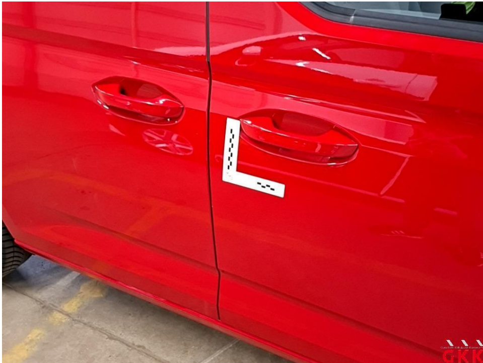
Bild 17 Tür vorne rechts, beschädigt, kalt drücken
