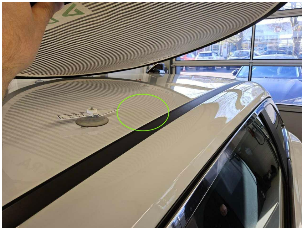
Bild 10 : Dach, Restspuren aus Instandsetzung, noch Dellen vorhanden
