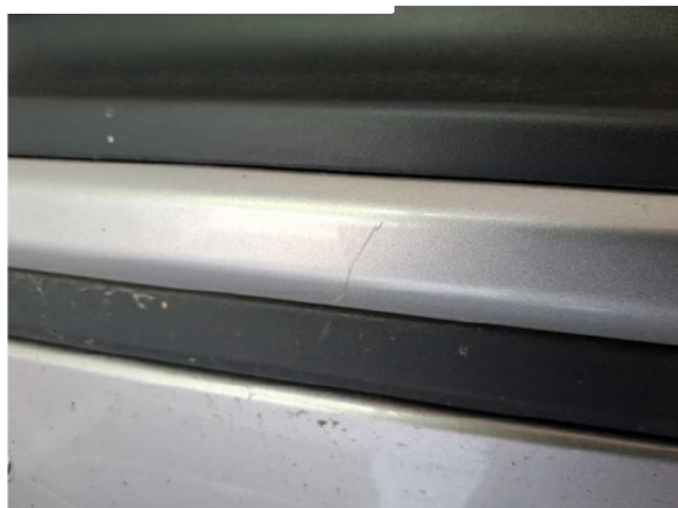
Beschädigung 1: Stossfänger hinten: Stossfänger hinten - Kratzer - Smart Repair
