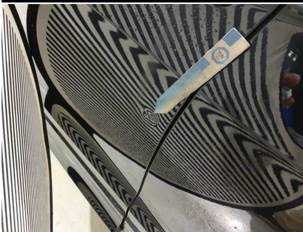
Beschädigung #4: Tür vorn links: Tür - Delle / Lackschaden - instandsetzen und lackieren
