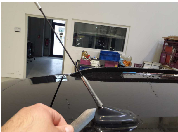
Beschädigung #1: Fahrzeugdach: Antennenstab - abweichend Auslieferungszustand - erneuern
