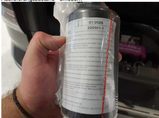
Beschädigung #2: Ausrüstung: Tirefit Füllmittel - abgelaufen - erneuern
