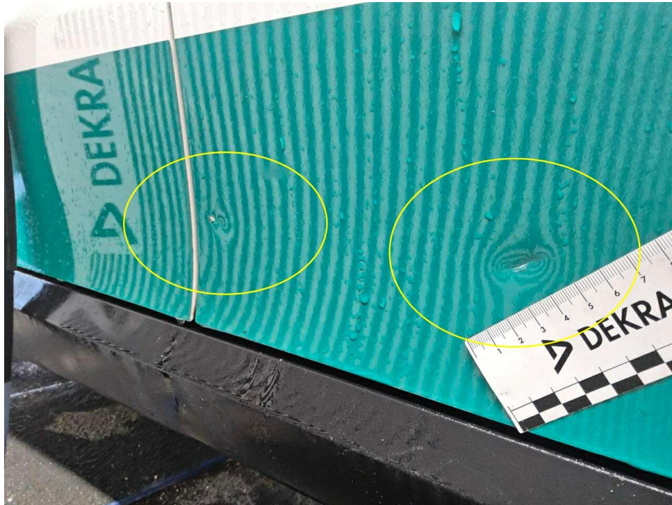
Bild 19 : Tür vorne rechts, deformiert, instandsetzen und lackieren mit Lackaufbau
