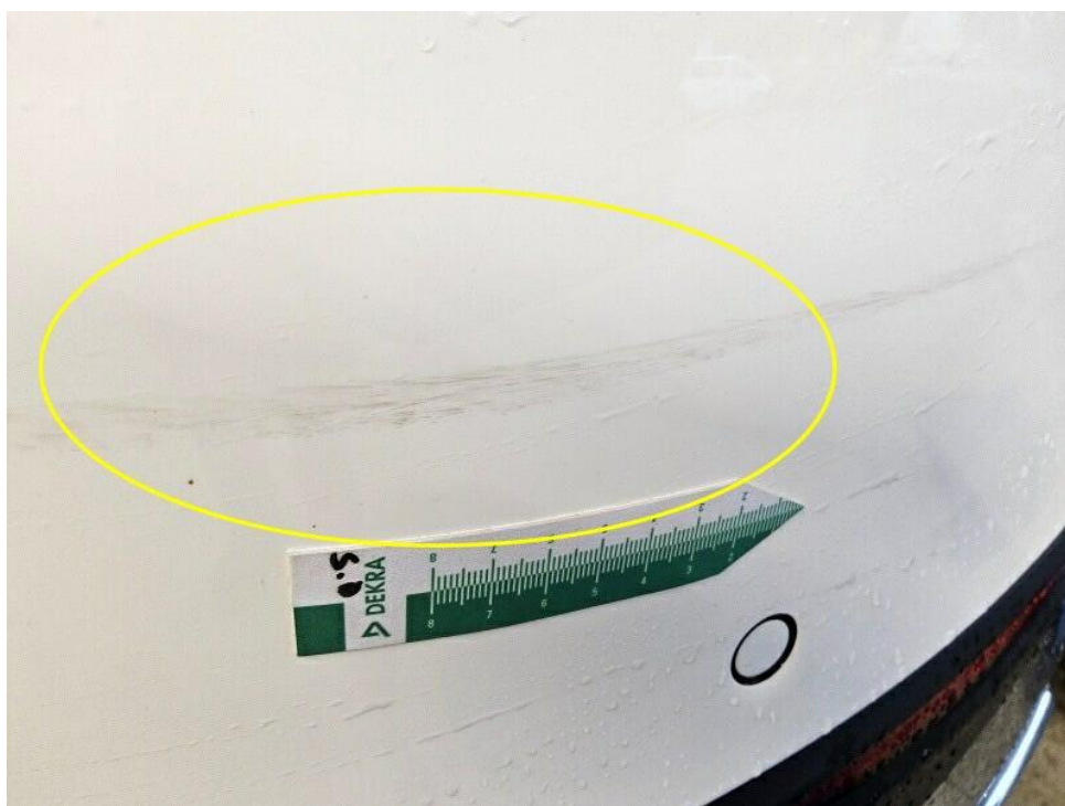
Bild 24 : Stoßfänger hinten verschrammt
