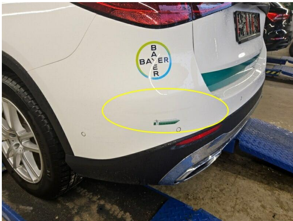
Bild 23 : Stoßfänger hinten verschrammt
