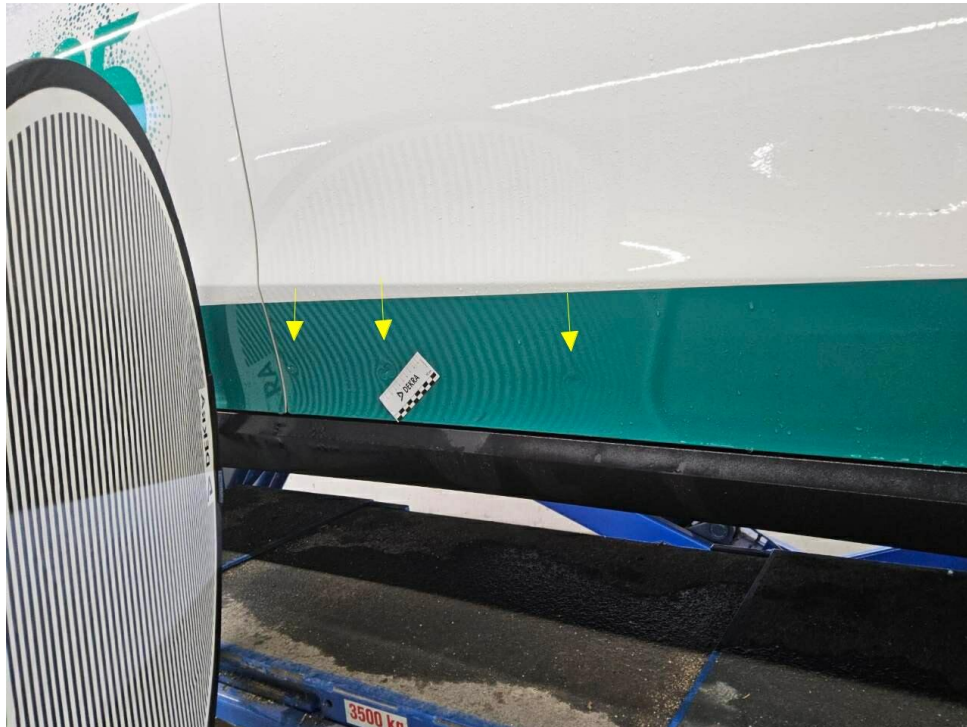
Bild 17 : Tür vorne rechts, deformiert, instandsetzen und lackieren mit Lackaufbau
