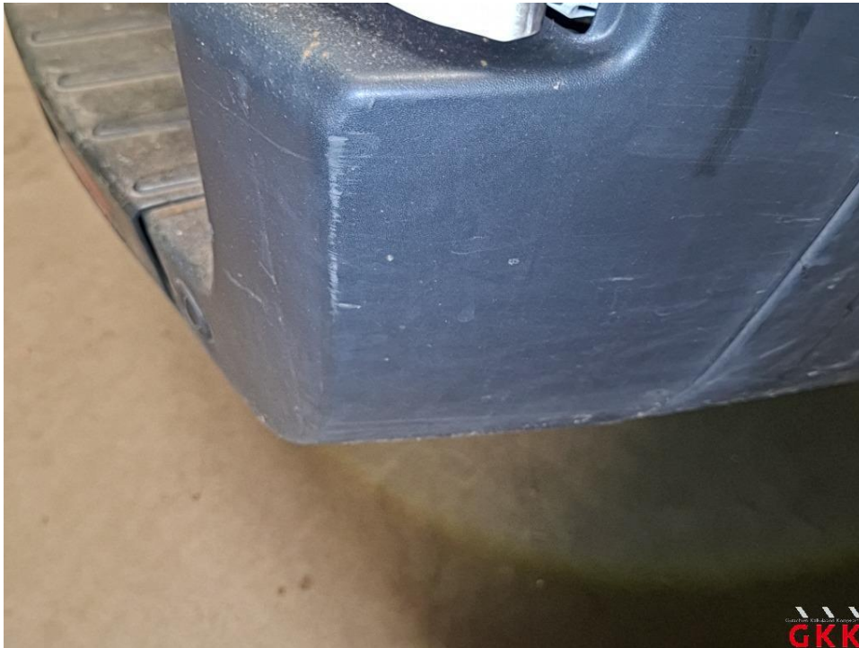
Bild 49 Stoßfänger hinten, Ecke rechts -unlackiert-, verkratzt, ersetzen
