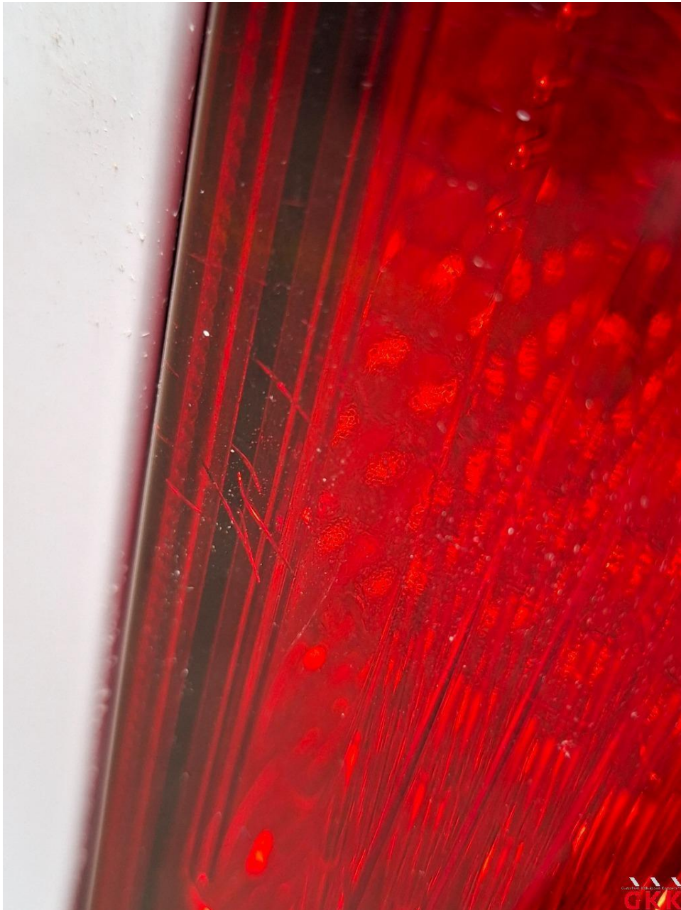
Bild 53 Rückleuchte rechts, außen, verkratzt, ersetzen
