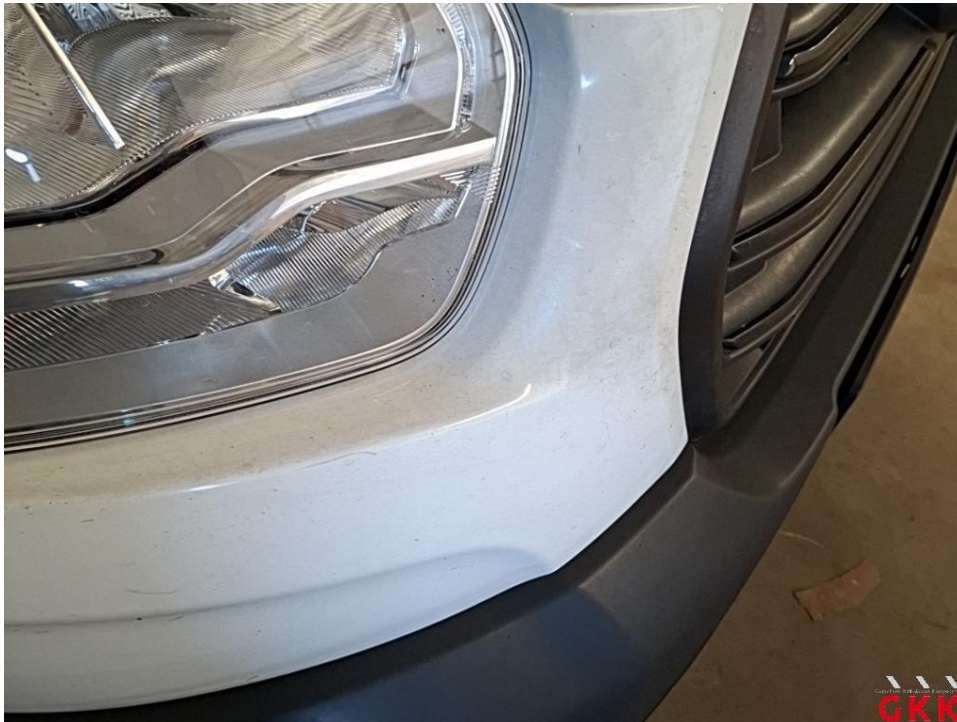
Bild 19 Fahrzeug, außen, Lackierung verwittert / matt, aufbereiten
