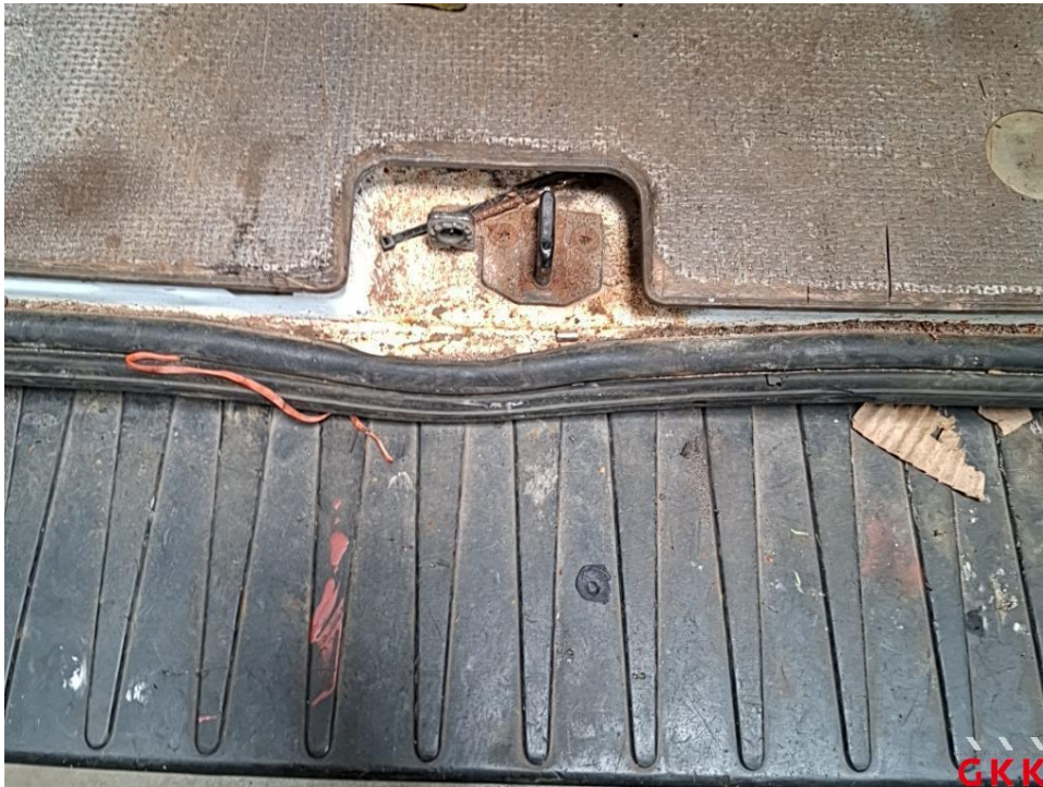
Bild 51 Heckklappe, Dichtung, beschädigt, ersetzen
