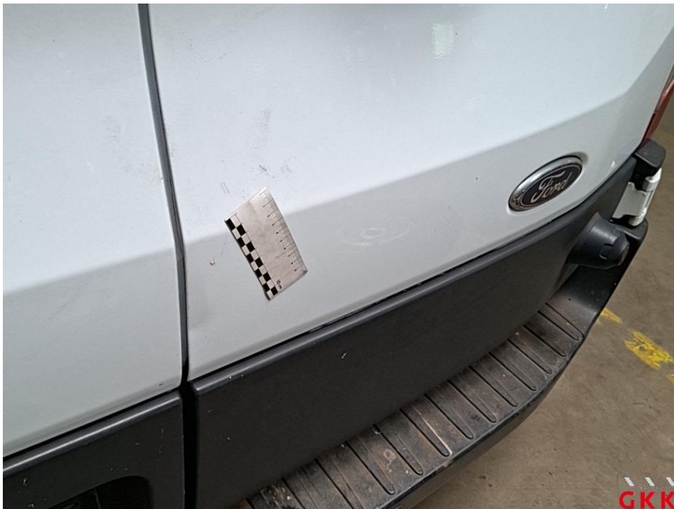
Bild 36 Hecktür rechts, beschädigt, instand setzen - lackieren
