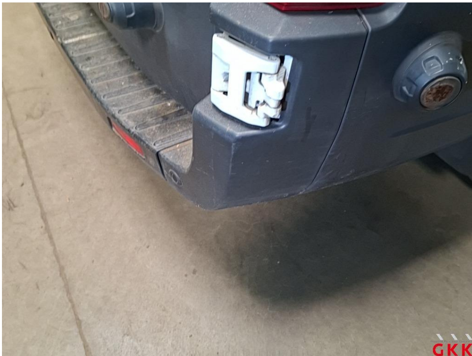
Bild 48 Stoßfänger hinten, Ecke rechts -unlackiert-, verkratzt, ersetzen
