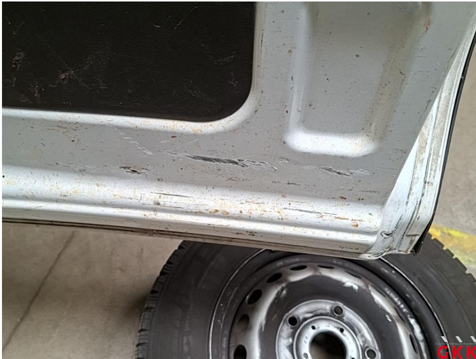
Bild 39 Hecktür rechts, innen, beschädigt, Smartrepair
