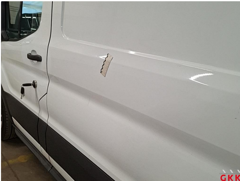
Bild 28 Seitenwand links, vorne, beschädigt, instand setzen - lackieren
