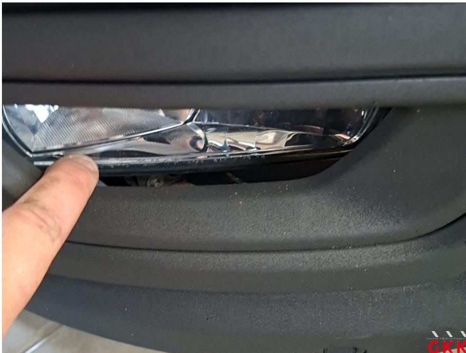
Bild 22 Nebelscheinwerfer, rechts, lose, ersetzen
