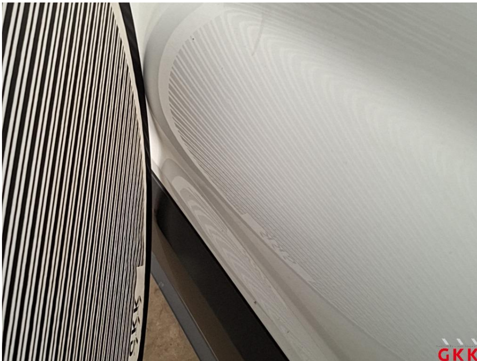
Bild 30 Seitenwand links, vorne, beschädigt, instand setzen - lackieren
