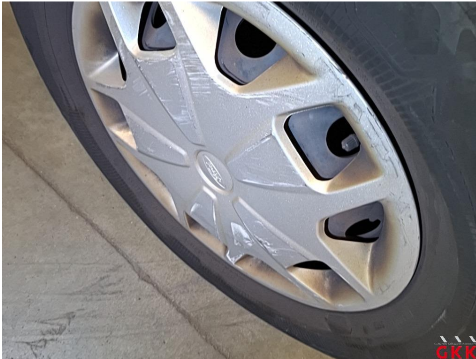
Bild 47 Radkappe(n), hinten links, beschädigt, ersetzen
