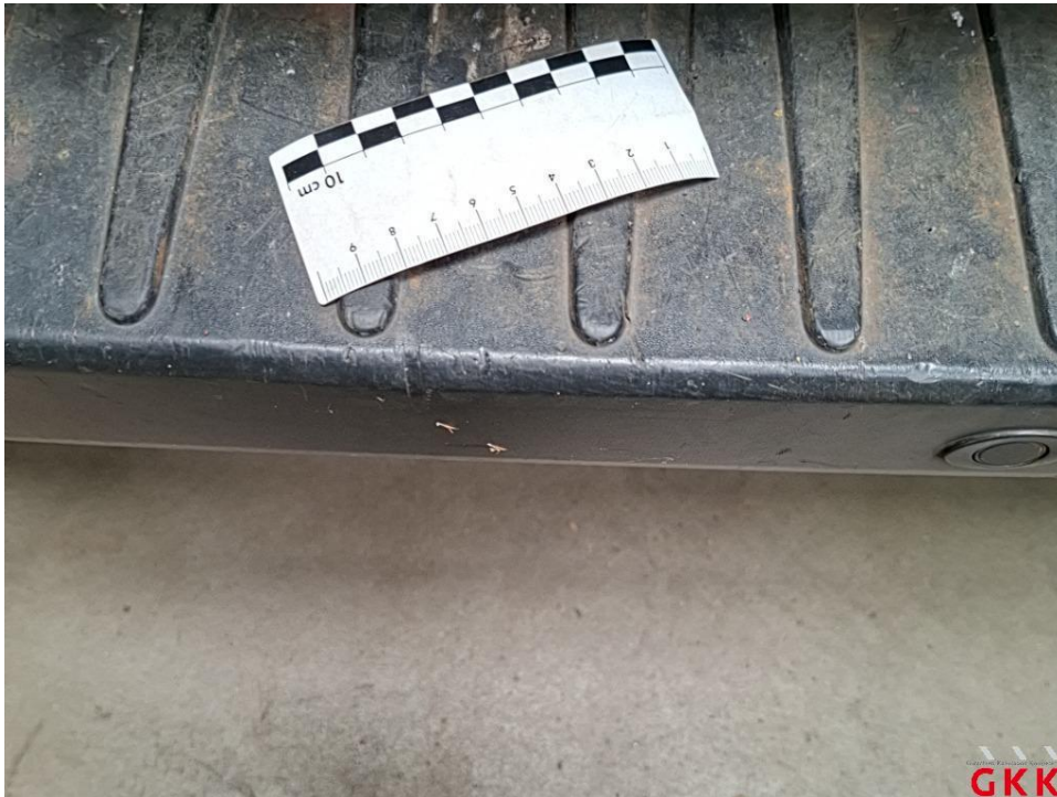
Bild 45 Stoßfänger hinten, Verkleidung -unlackiert-, beschädigt, ersetzen
