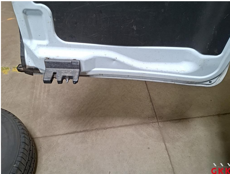
Bild 40 Hecktür links, innen, beschädigt, Smartrepair
