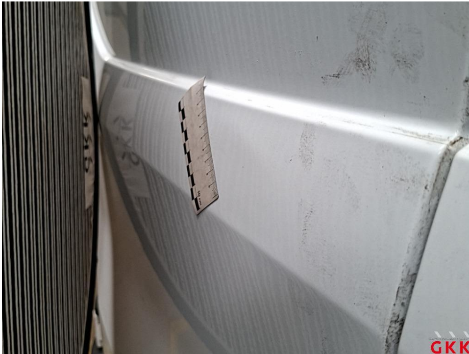
Bild 35 Hecktür links, beschädigt, instand setzen - lackieren
