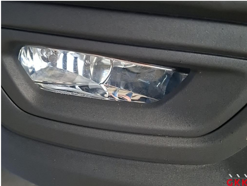
Bild 21 Nebelscheinwerfer, rechts, lose, ersetzen
