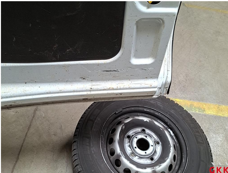
Bild 38 Hecktür rechts, innen, beschädigt, Smartrepair
