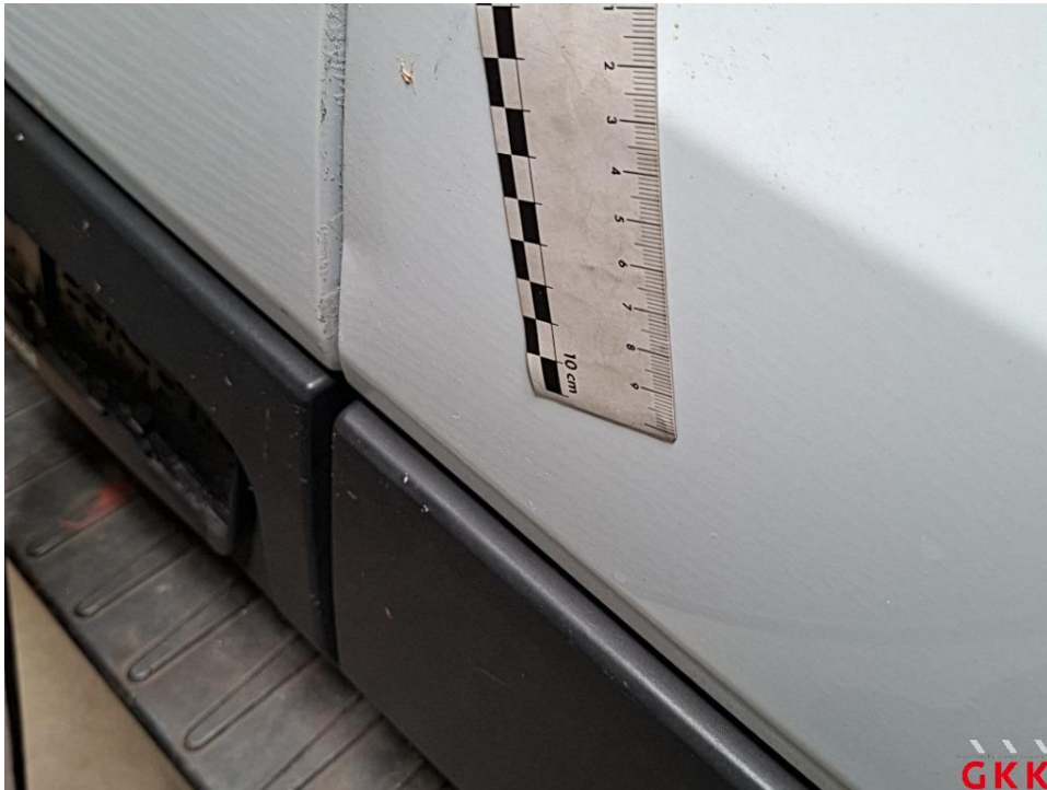
Bild 37 Hecktür rechts, beschädigt, instand setzen - lackieren
