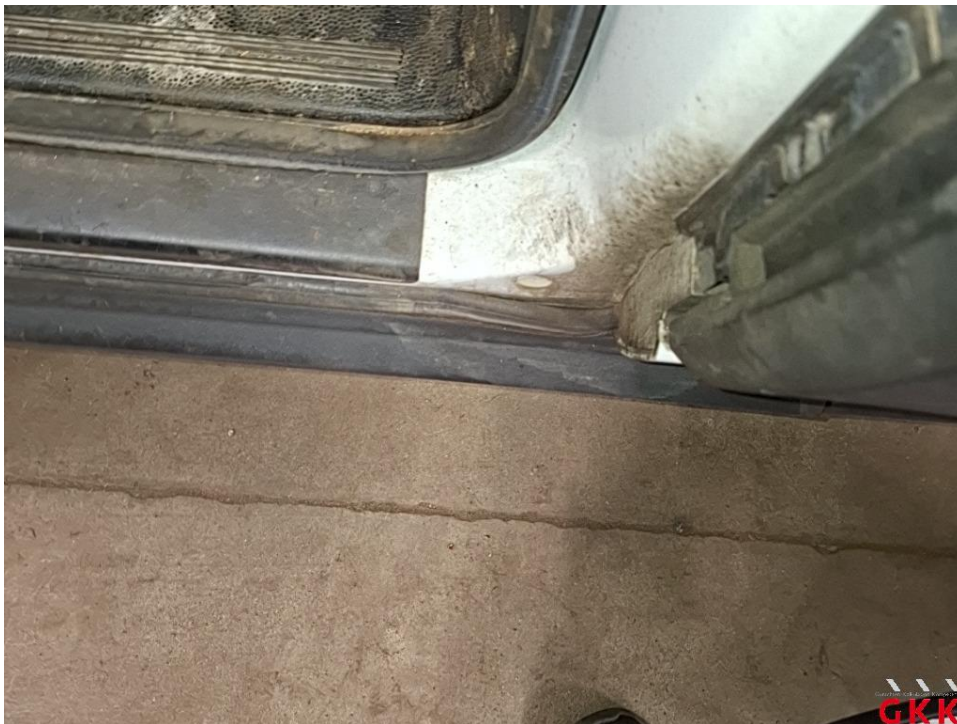
Bild 26 Tür vorne links, Dichtung -Einstieg-, beschädigt, ersetzen
