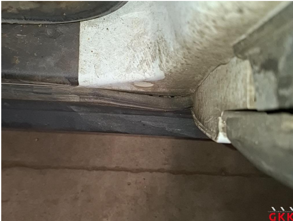
Bild 27 Tür vorne links, Dichtung -Einstieg-, beschädigt, ersetzen
