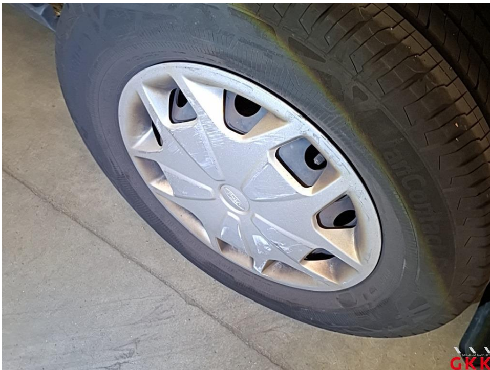
Bild 46 Radkappe(n), hinten links, beschädigt, ersetzen
