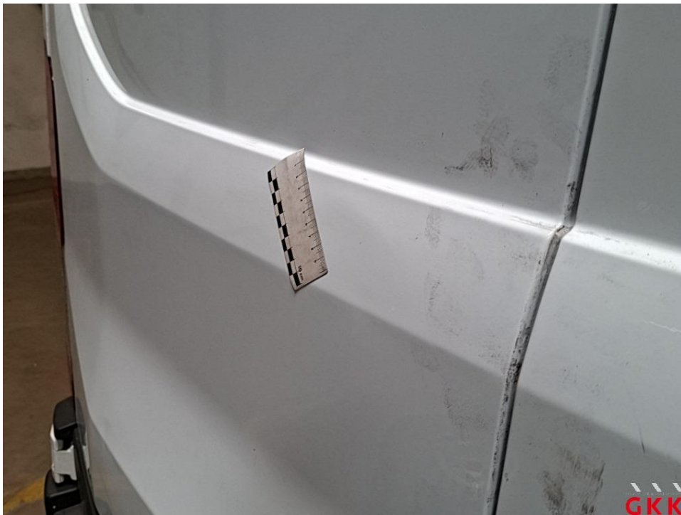
Bild 34 Hecktür links, beschädigt, instand setzen - lackieren
