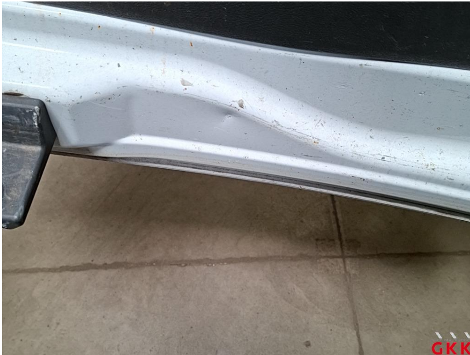
Bild 41 Hecktür links, innen, beschädigt, Smartrepair
