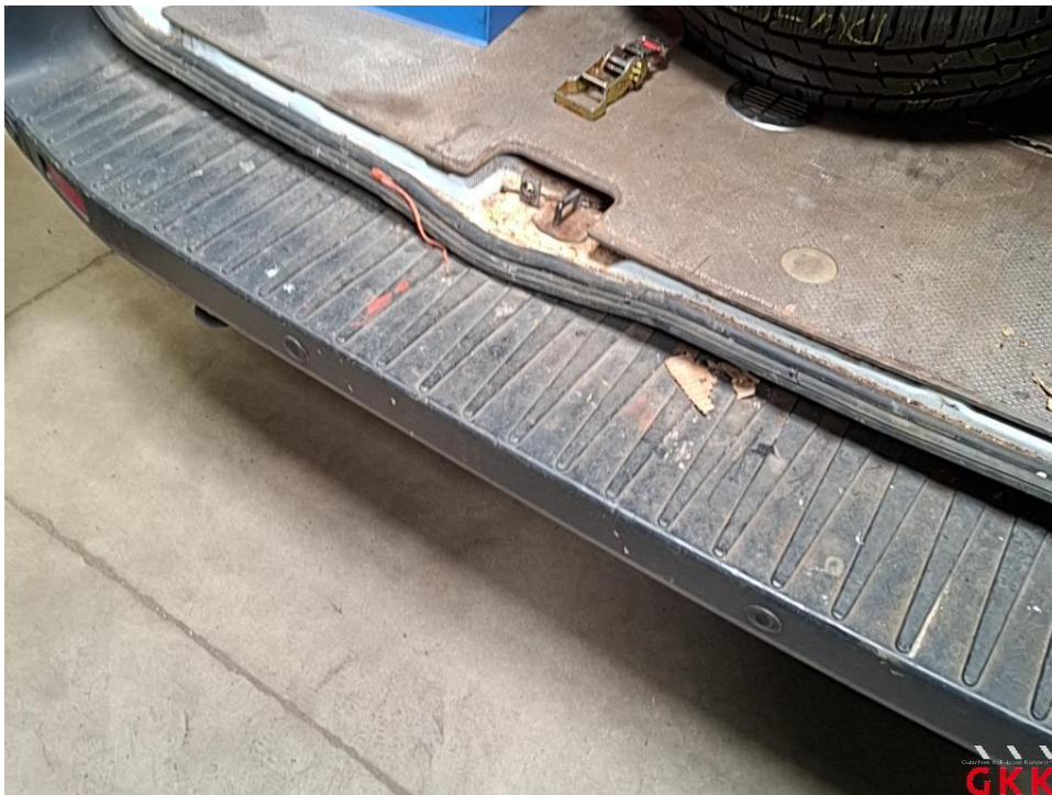
Bild 50 Heckklappe, Dichtung, beschädigt, ersetzen
