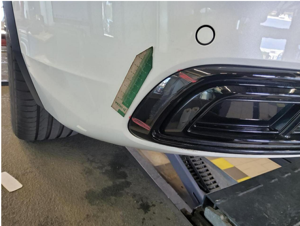
Bild 15 : Heckschürze hinten unten Lackierung, verschrammt, Gebrauchsspur
