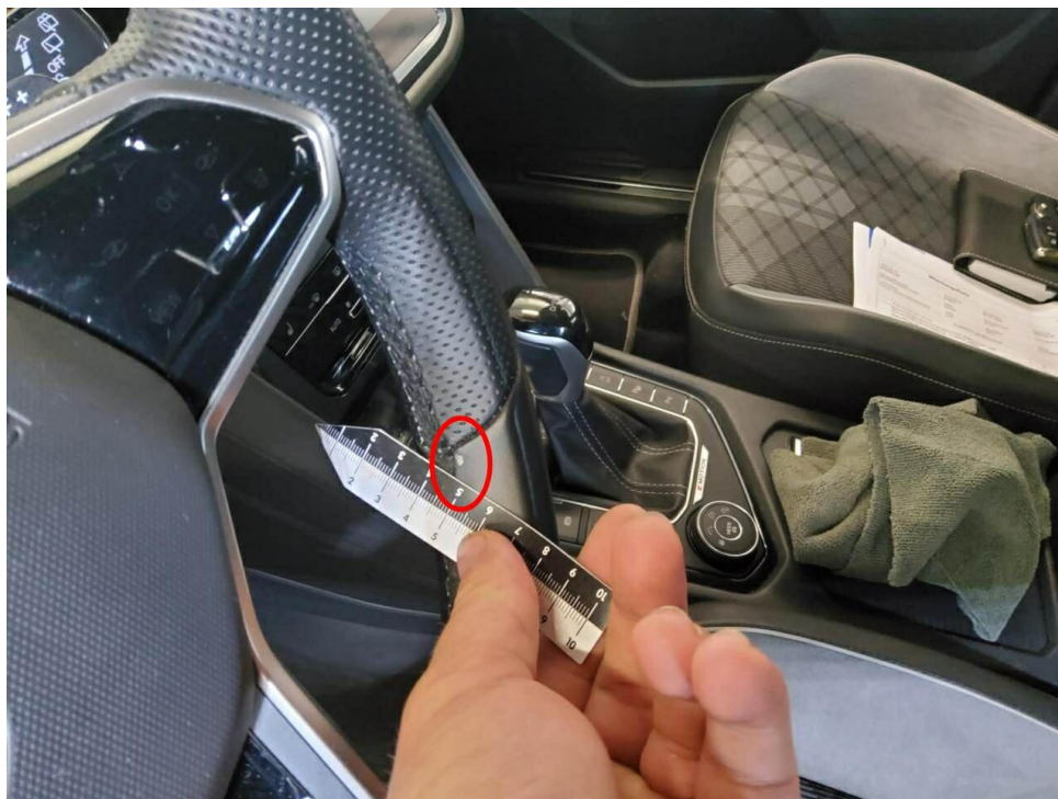
Bild 13 : Lenkrad, zerkratzt, smart repair
