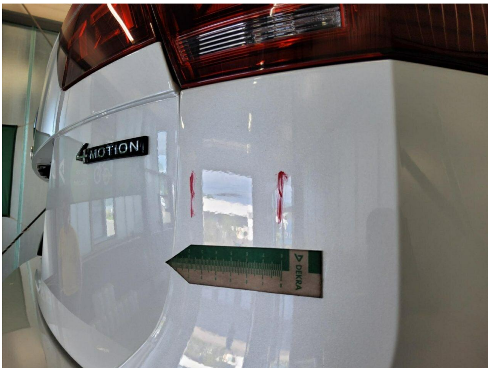
Bild 16 : Stoßfänger hinten Lackierung, verschrammt, Gebrauchsspur
