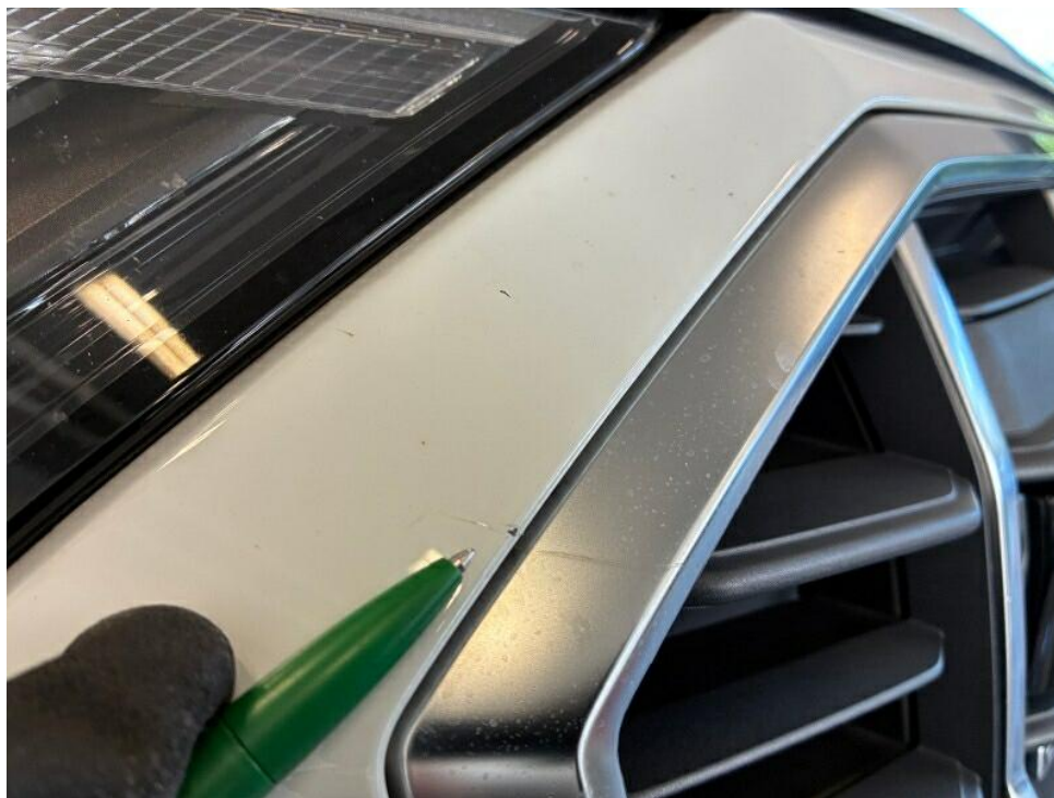
Bild 17 : Stoßfänger vorne Kratzer + Steinschlag
