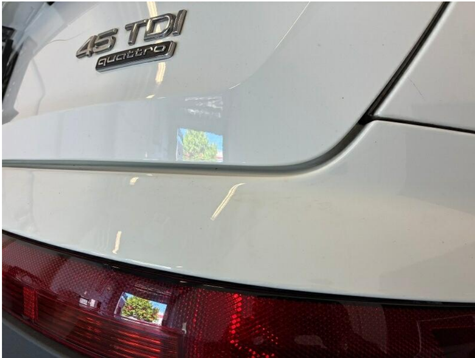
Bild 20 : Stoßfänger hinten Restreparaturspuren + Farbunterschied
