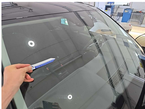
Beschädigung #4: Verglasung: Frontscheibe - Steinschlag - erneuern
