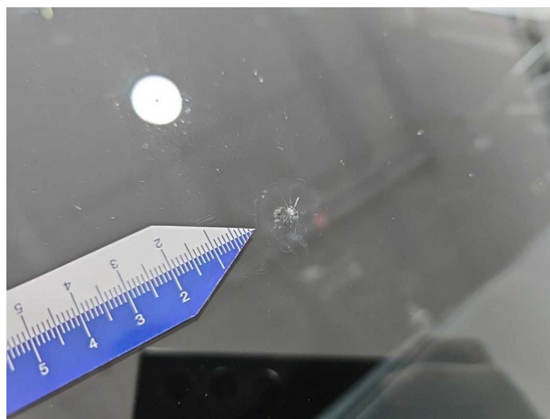
Beschädigung #4: Verglasung: Frontscheibe - Steinschlag - erneuern
