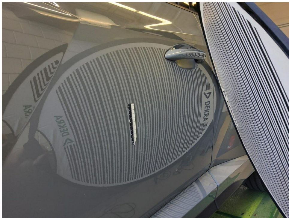
Bild 12 : Tür vorne links, eingedellt, drücken
