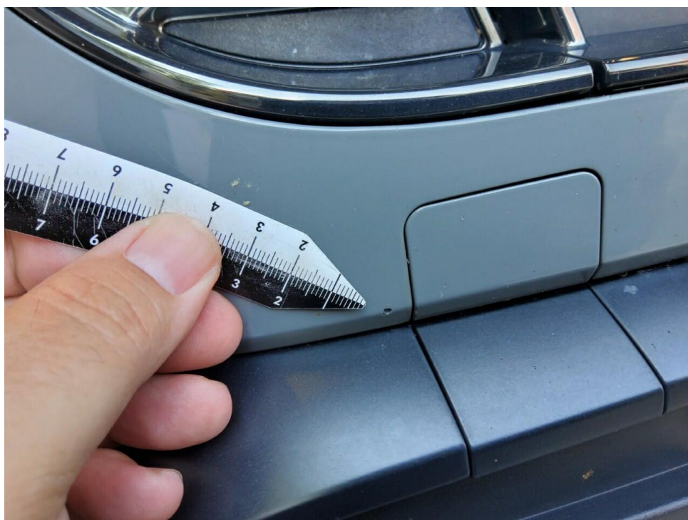
Bild 8 : Stoßfänger vorne Lackierung, Steinschlag, Gebrauchsspur
