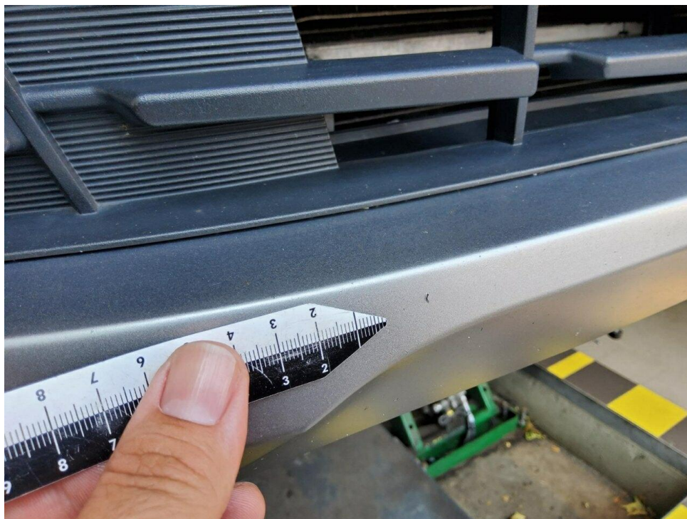
Bild 7 : Frontspoiler Lackierung, Steinschlag, Gebrauchsspur
