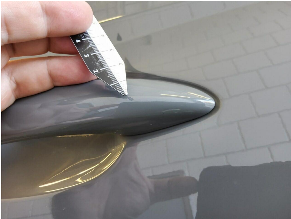
Bild 13 : Tür vorne rechts Türgriff, zerkratzt, Gebrauchsspur
