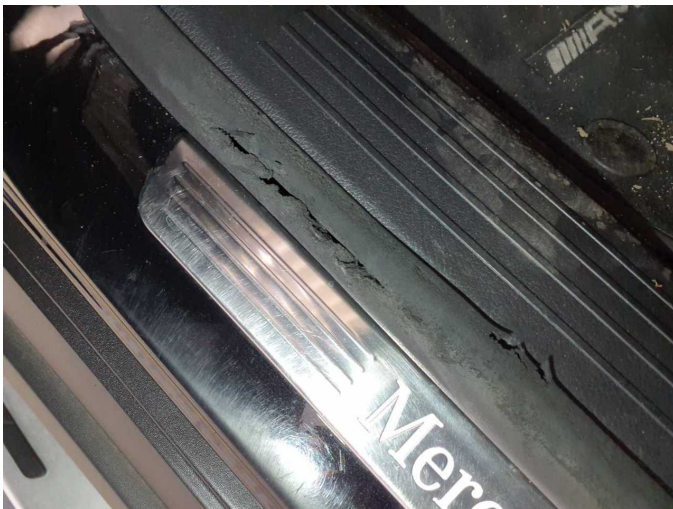
Damage 7: Door - front left side: Door seal - Broken / torn - Replace
