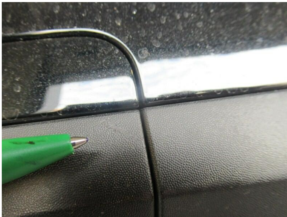
Bild 16 : Deckel der Abschleppöse gekerbt
