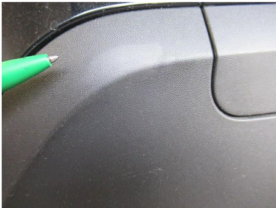
Bild 15 : Stoßfängerunterteil / Spoiler mitte hinten gekerbt
