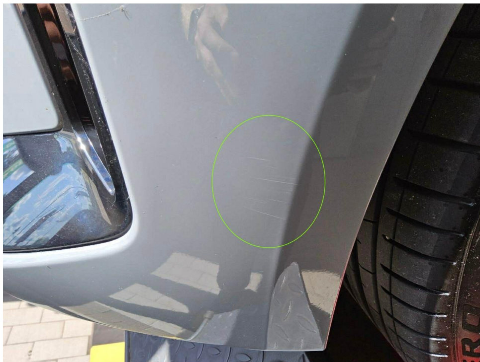
Bild 15 : Stoßfängerverkleidung vorne vereinzelt Steinschläge und Oberflächenkratzer
