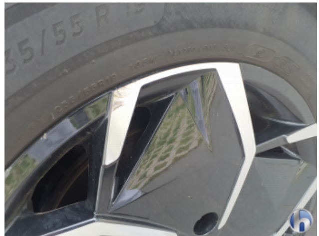
1. Felge Vorne - Rechts Unfallschaden - Smart Repair
