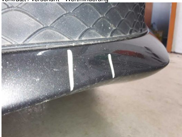
Beschädigung #3: Stossfänger vorn: Stossfänger vorn - verkratzt / verschürft - Wertminderung
