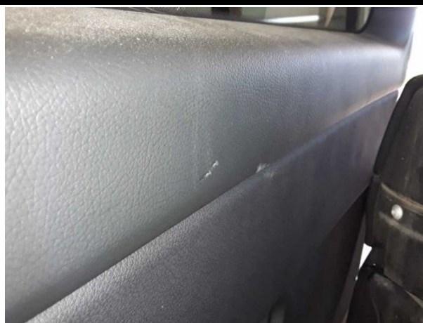
Beschädigung #4: Verkleidungen/Abdeckungen: Türverkleidung hinten rechts - beschädigt - Wertminderung
