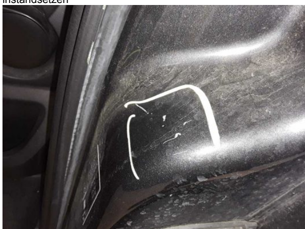
Beschädigung #6: Schweller links: Einstieg - verkratzt / verschürft - Smart Repair
