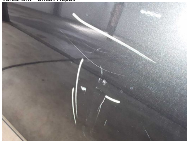
Beschädigung #10: Schiebetür rechts: Schiebetür mit Glasscheibe - Delle / Lackschaden - instandsetzen und
