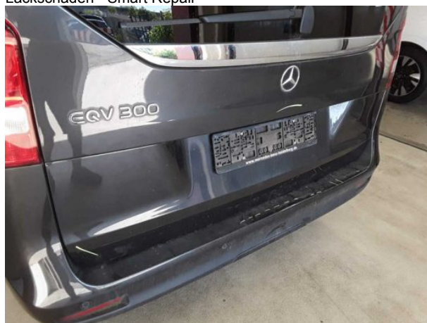
Beschädigung #9: Heckklappe/-tür: Heckklappe - verkratzt / verschürft - Smart Repair
