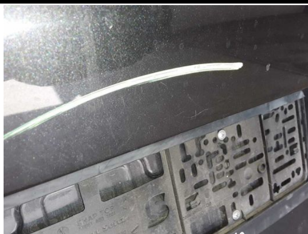
Beschädigung #9: Heckklappe/-tür: Heckklappe - verkratzt / verschürft - Smart Repair
