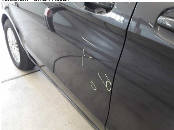
Beschädigung #10: Schiebetür rechts: Schiebetür mit Glasschei... - Delle / Lackschaden - instandsetzen und lackieren
