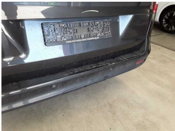
Beschädigung #2: Stossfänger hinten: Stossfänger hinten - verkratzt / verschürft - Wertminderung
