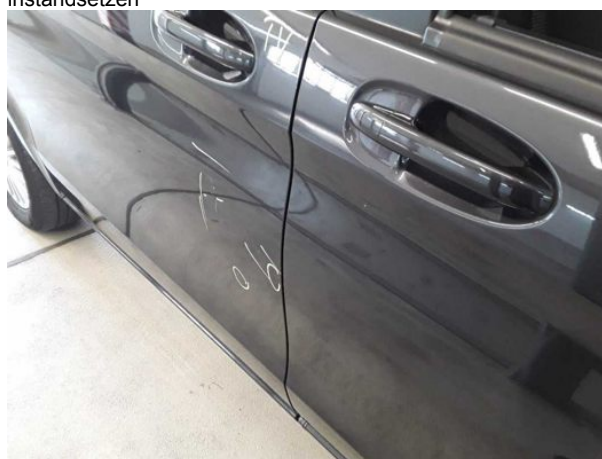
Beschädigung #7: Tür vorn rechts: Tür - Delle / Lackschade... Smart Repair
