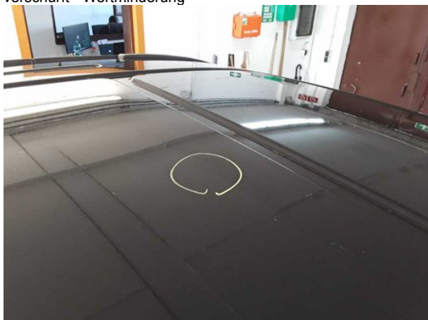
Beschädigung #5: Fahrzeugdach: Dach - Delle(n) - sanft instandsetzen
