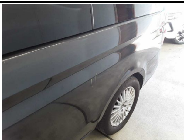
Beschädigung #8: Seitenwand links: Seitenwand - Delle / Lackschaden - Smart Repair
