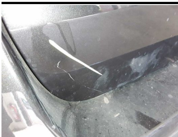
Beschädigung #9: Heckklappe/-tür: Heckklappe - verkratzt / verschürft - Smart Repair
