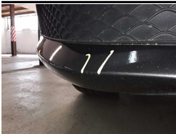
Beschädigung #3: Stossfänger vorn: Stossfänger vorn - verkratzt / verschürft - Wertminderung
