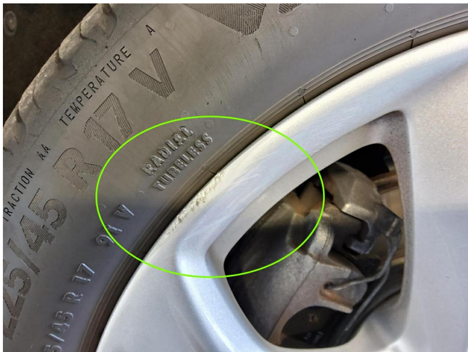
Bild 17 : Felge vorne links Lackierung, zerkratzt, smart repair
