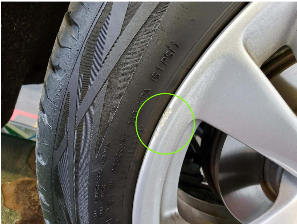
Bild 15 : Felge vorne rechts Lackierung, zerkratzt, Gebrauchsspur
