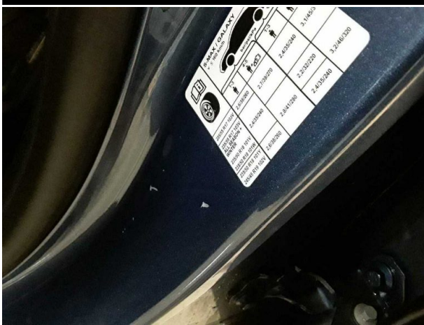
Beschädigung #5: Schweller links: Einstieg - Delle / Lackschade... Smart Repair
