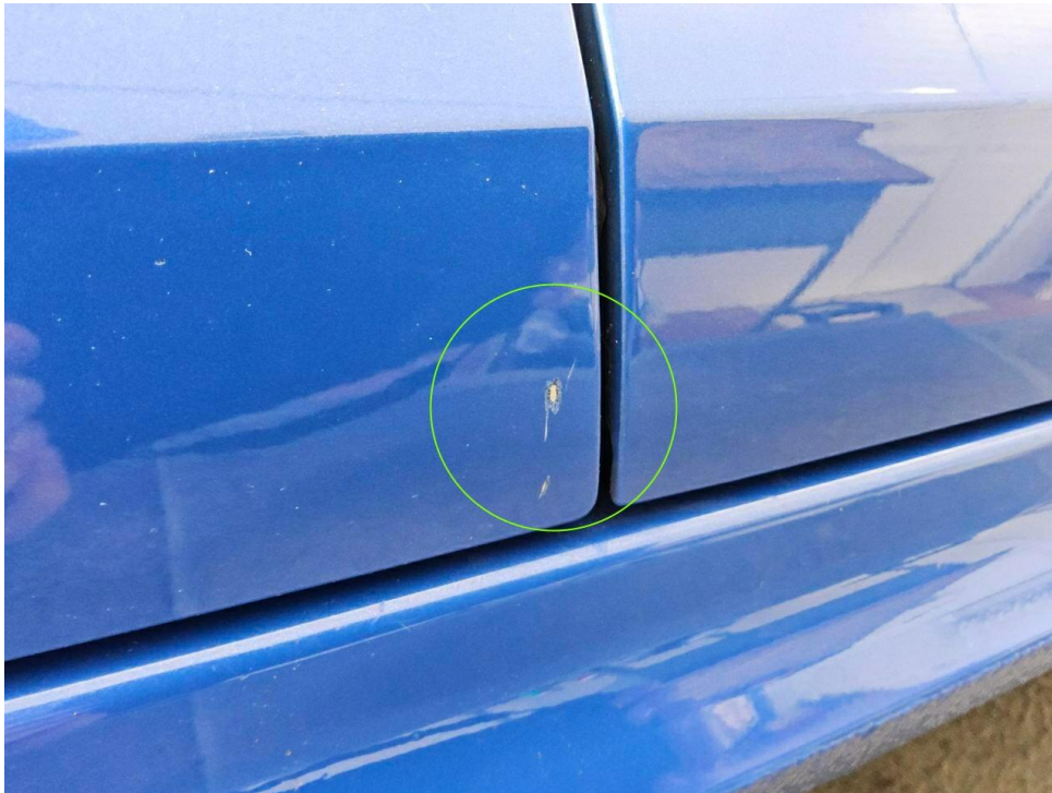
Bild 19 : Tür vorne links Lackierung, zerkratzt, smart repair
