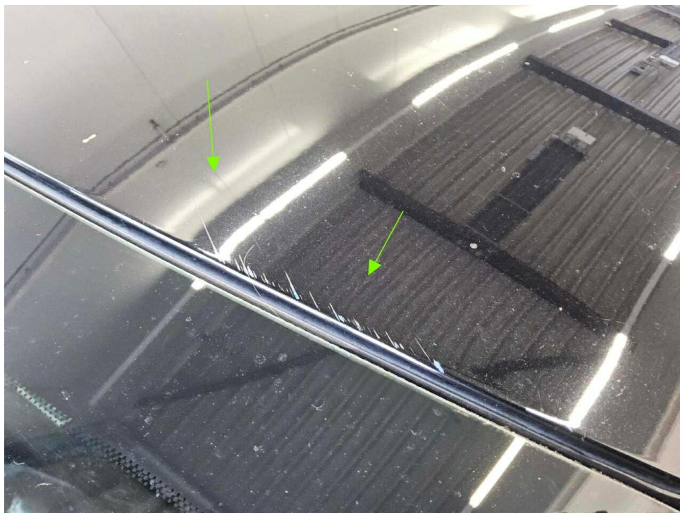
Bild 25 : Dach Lackierung, zerkratzt, smart repair
