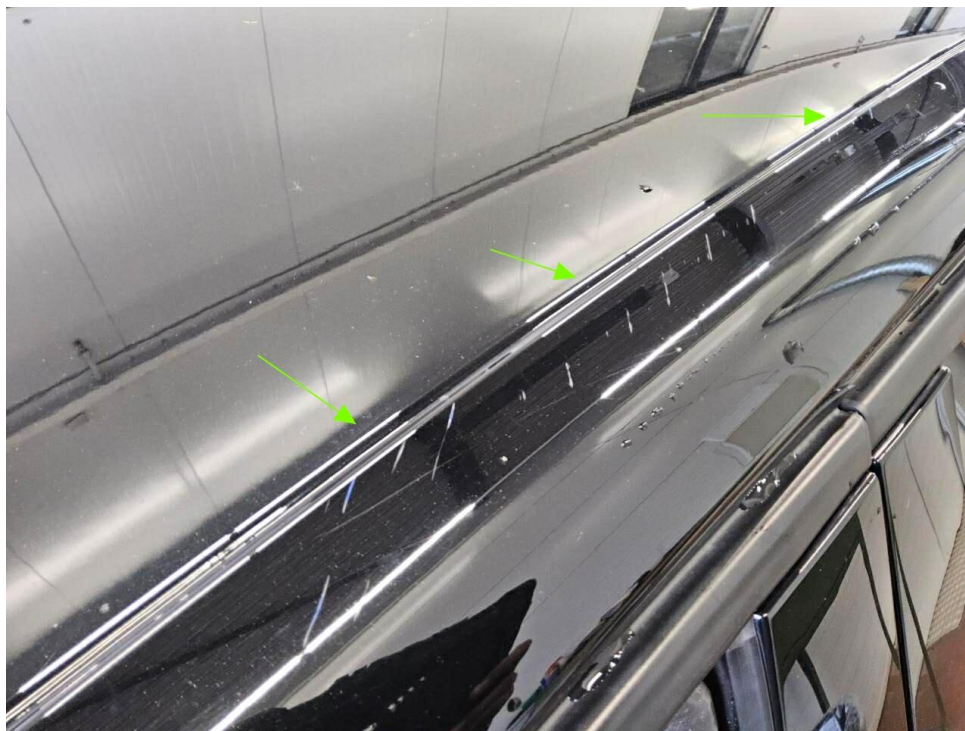
Bild 22 : Dachrahmen links Lackierung, verschrammt, lackieren mit Lackaufbau
