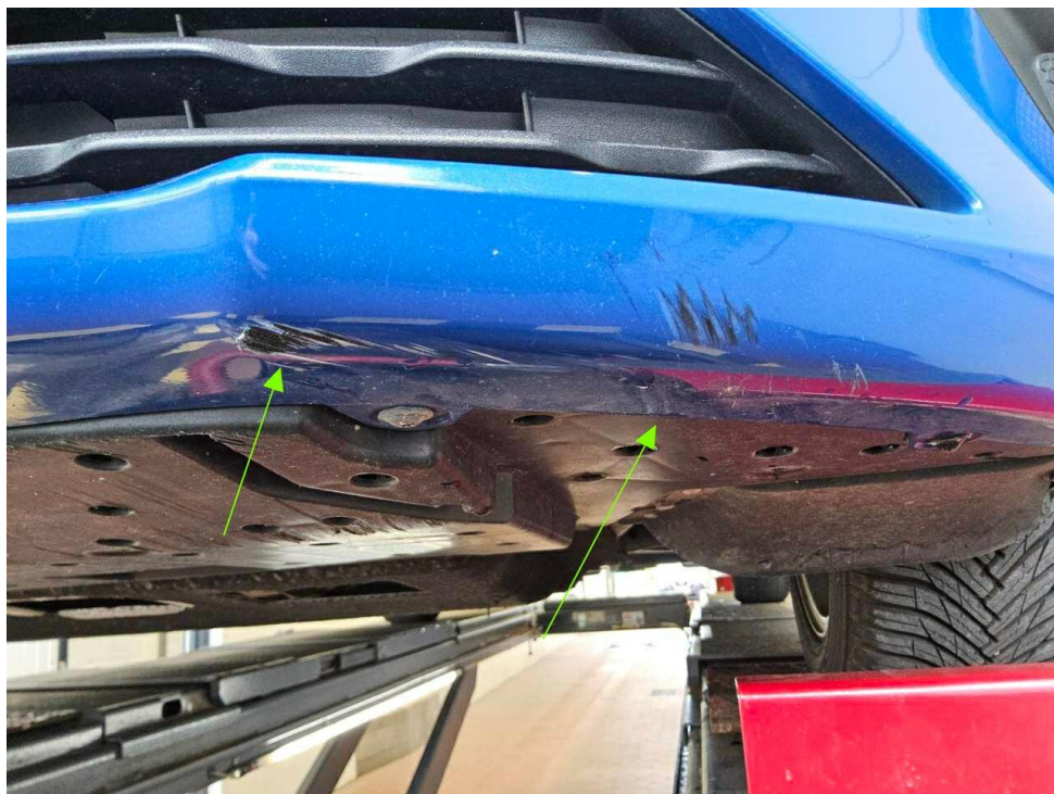
Bild 18 : Frontspoiler Lackierung, verschrammt, lackieren mit Lackaufbau
