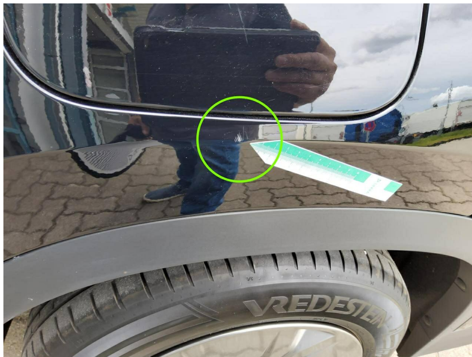
Bild 15 : Seitenteil hinten rechts Lackierung, zerkratzt, smart repair
