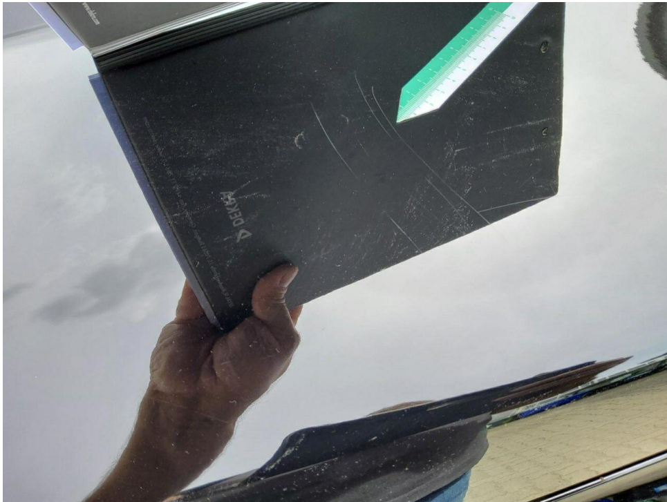
Bild 21 : Motorhaube Lackierung, zerkratzt, lackieren
