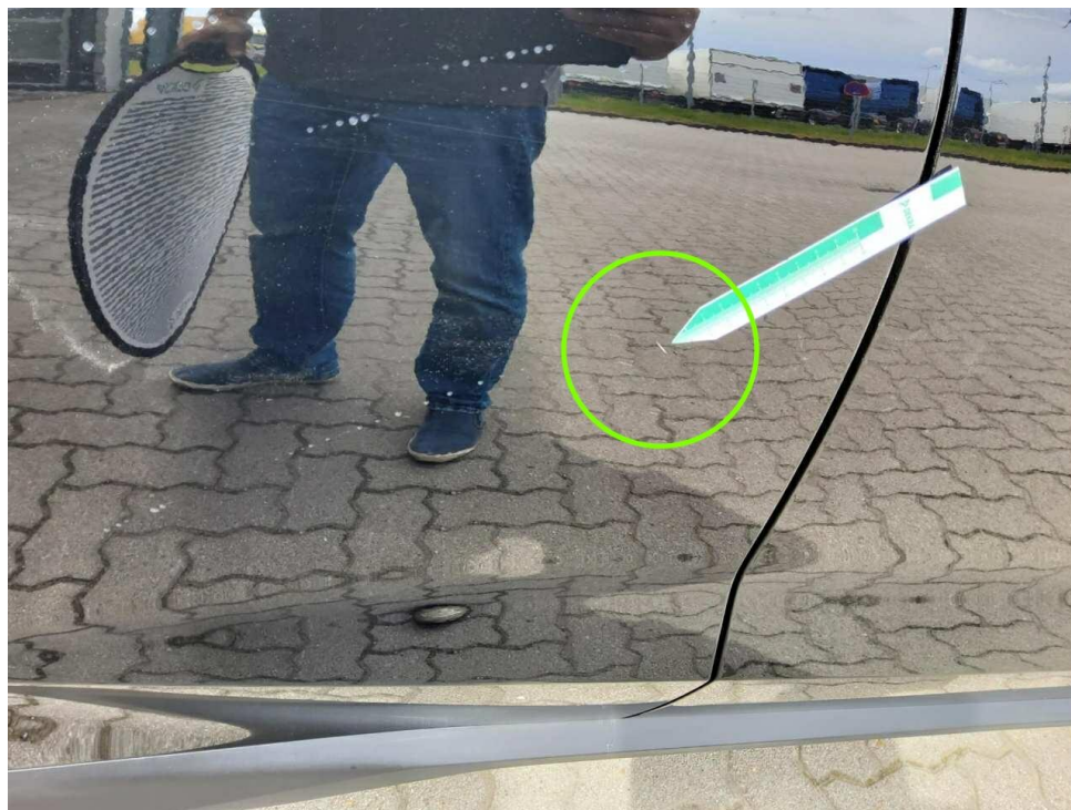
Bild 16 : Tür hinten rechts Lackierung, zerkratzt, lackieren
