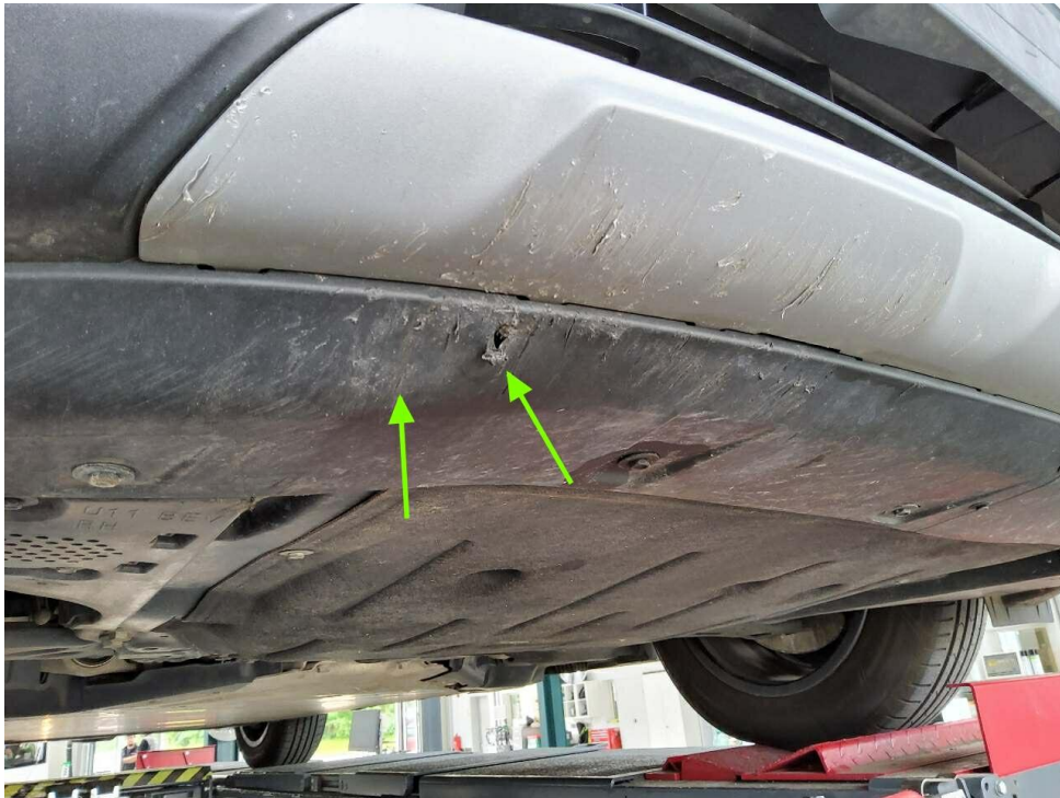
Bild 25 : Unterbodenverkleidung vorne rechts deformiert
