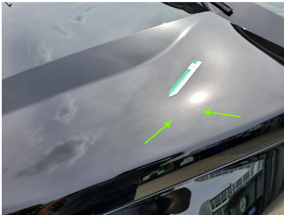
Bild 20 : Motorhaube Lackierung, zerkratzt, lackieren
