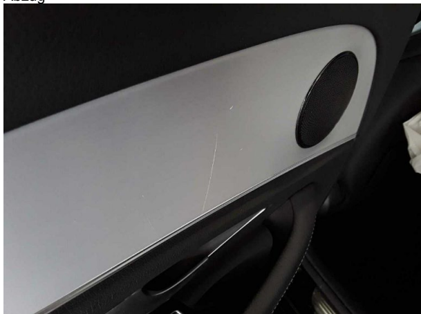
Beschädigung #2: Verkleidungen/Abdeckungen: Zierleiste / Dekorleiste (Tür hi. Links) - verkratzt / verschürft - Wertminderung
