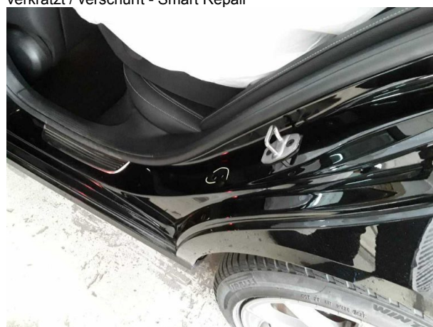
Beschädigung #9: Seitenwand links: Einstieg - Delle / Lackschaden - instandsetzen und lackieren
