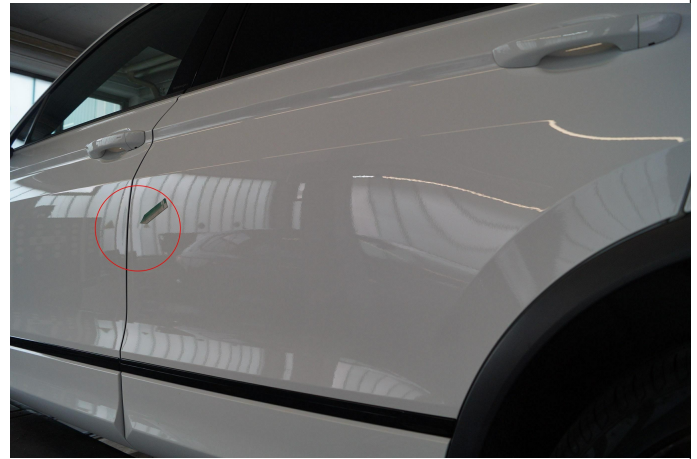
Bild 10: Außen, Tür hinten links, eingedellt, drücken
