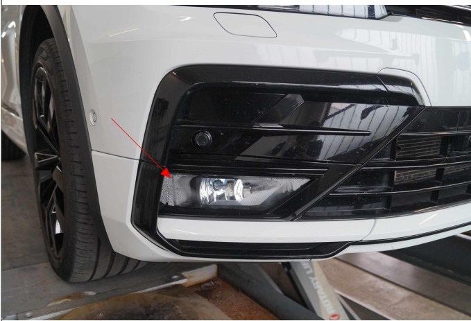
Bild 9: Außen, Nebelscheinwerfer re & li, undicht, prüfen und Befund festlegen, Schadenerweiterung möglich
