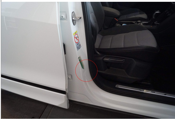
Bild 1: Außen, Tür vorne rechts - Einstieg, eingedellt, drücken
