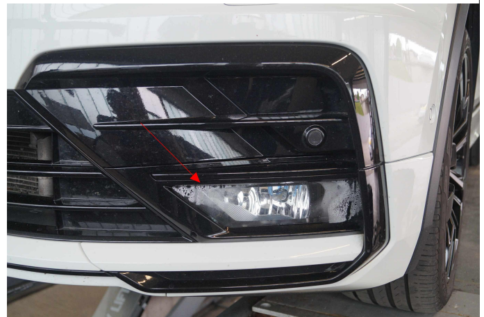
Bild 8: Außen, Nebelscheinwerfer re & li, undicht, prüfen und Befund festlegen, Schadenerweiterung möglich
