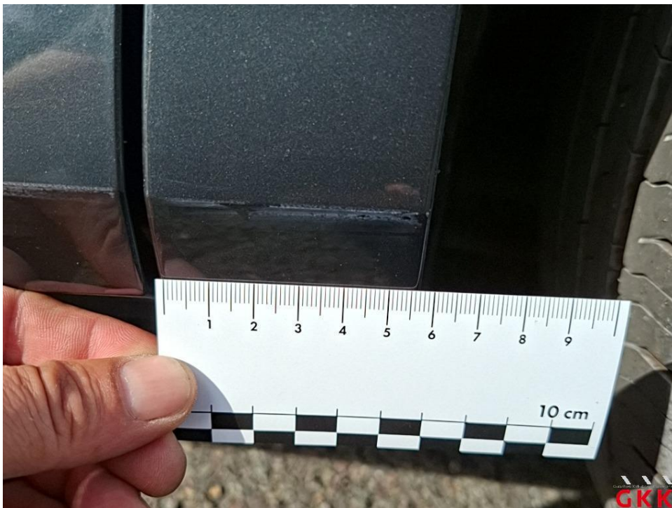
Bild 22. Seitenwand links, Leiste, Radlauf, verkratzt, Smartrepair
