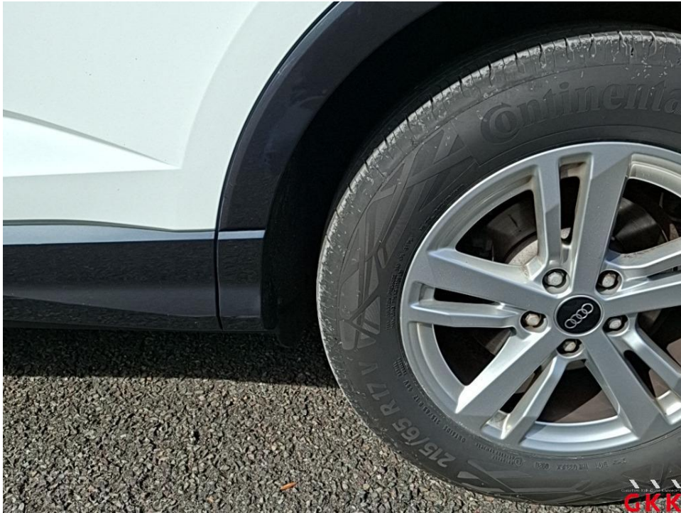
Bild 21. Seitenwand links, Leiste, Radlauf, verkratzt, Smartrepair
