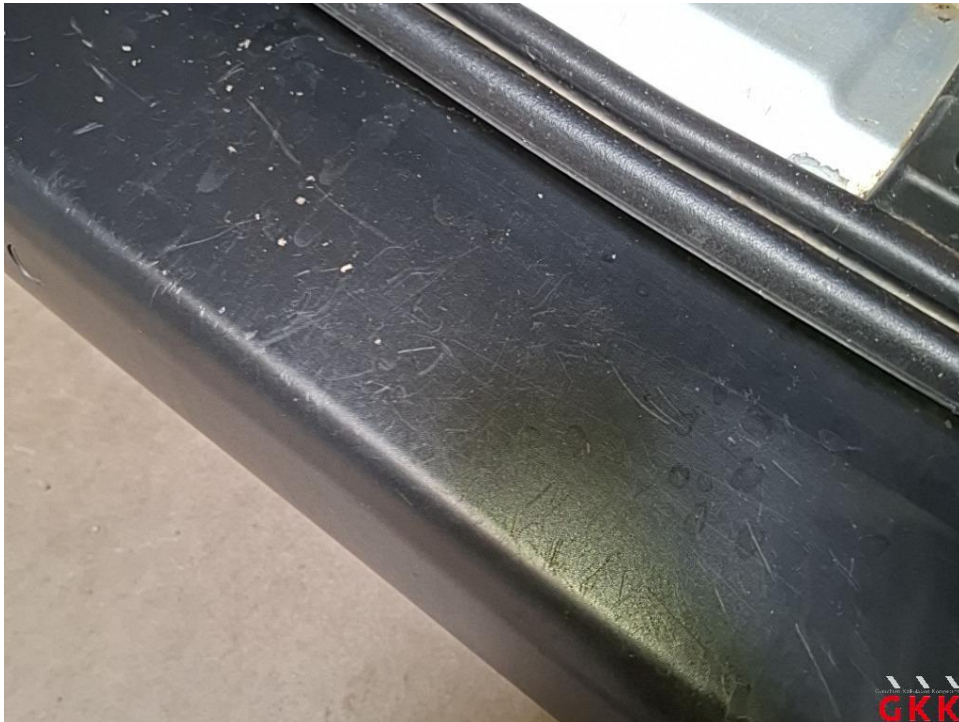
Bild 34 Stoßfänger hinten, Verkleidung -unlackiert-, verkratzt, Smartrepair
