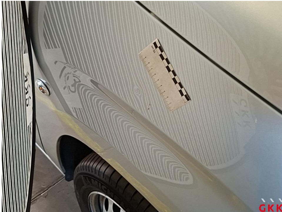
Bild 20 Kotflügel vorne rechts, beschädigt, instand setzen - lackieren
