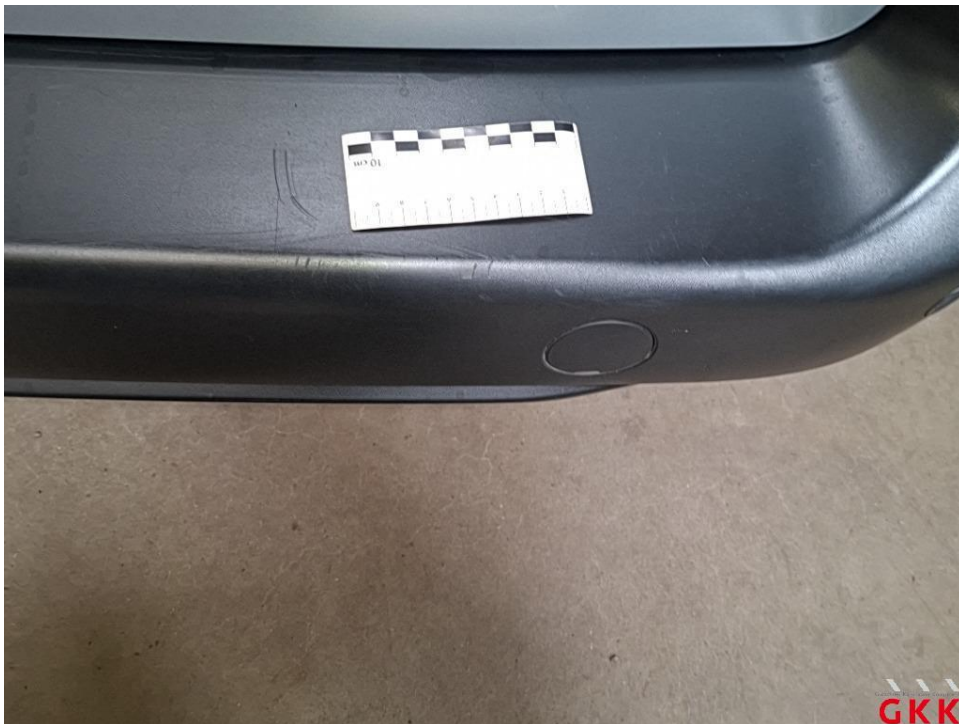
Bild 33 Stoßfänger hinten, Verkleidung -unlackiert-, verkratzt, Smartrepair
