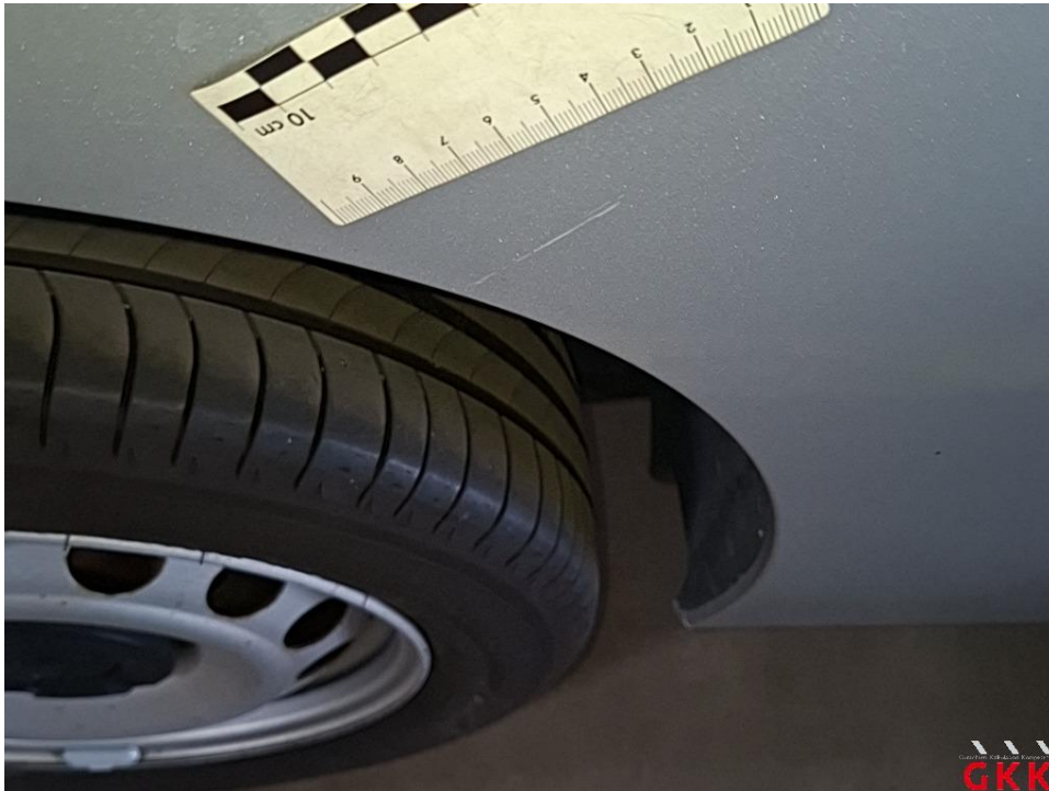
Bild 36 Seitenwand rechts, unterhalb, verkratzt, lackieren
