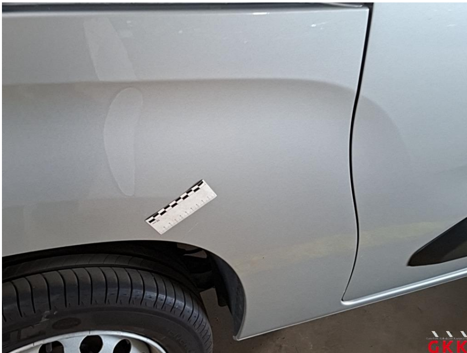
Bild 35 Seitenwand rechts, unterhalb, verkratzt, lackieren
