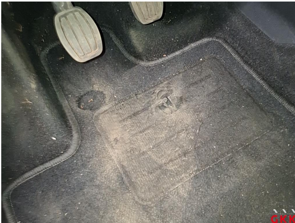
Bild 27 Fußmatte(n), vorne links, beschädigt, ersetzen
