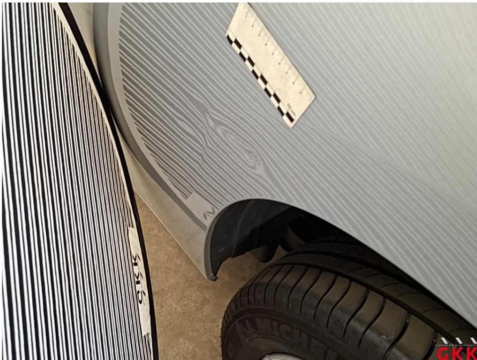
Bild 29 Seitenwand links, beschädigt, instand setzen - lackieren
