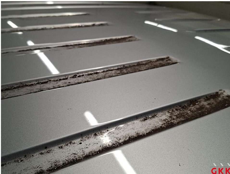
Bild 37 Fahrzeug, außen, Lackierung verwittert / matt, aufbereiten
