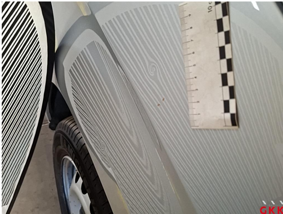
Bild 21 Kotflügel vorne rechts, beschädigt, instand setzen - lackieren
