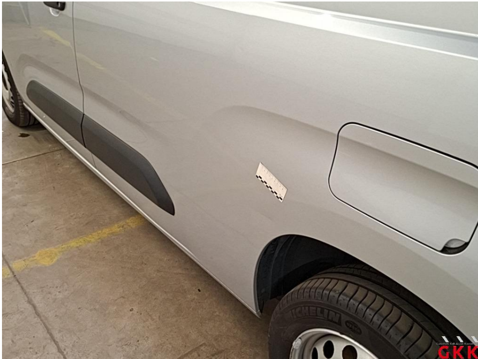
Bild 28 Seitenwand links, beschädigt, instand setzen - lackieren
