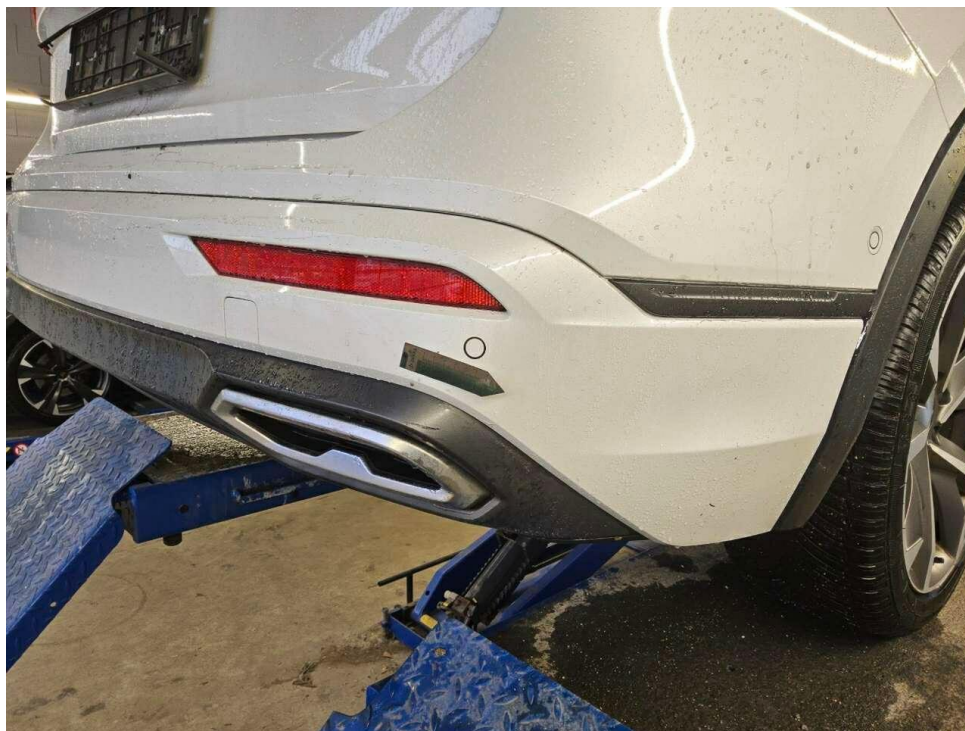
Bild 14 : Stoßfänger hinten Lackierung, zerkratzt, Gebrauchsspur
