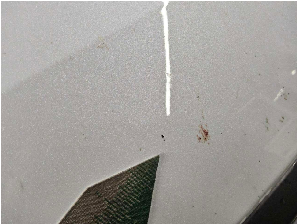
Bild 19 : Stoßfänger vorne Lackierung, Steinschlag, Gebrauchsspur
