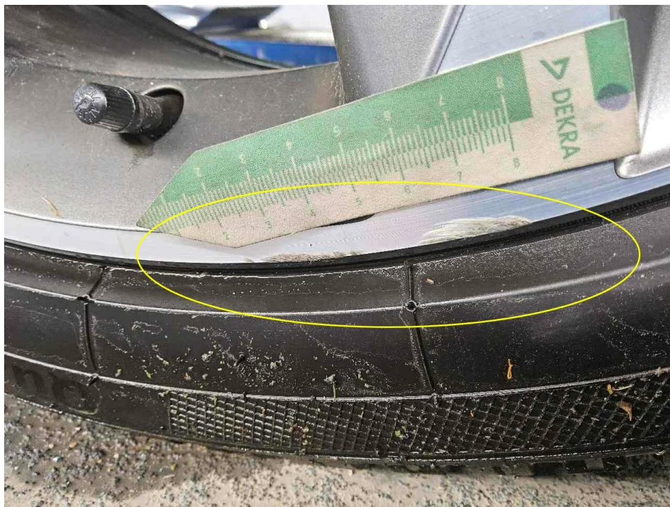
Bild 28 : LM Felge hinten rechts glanzgedreht verschrammt
