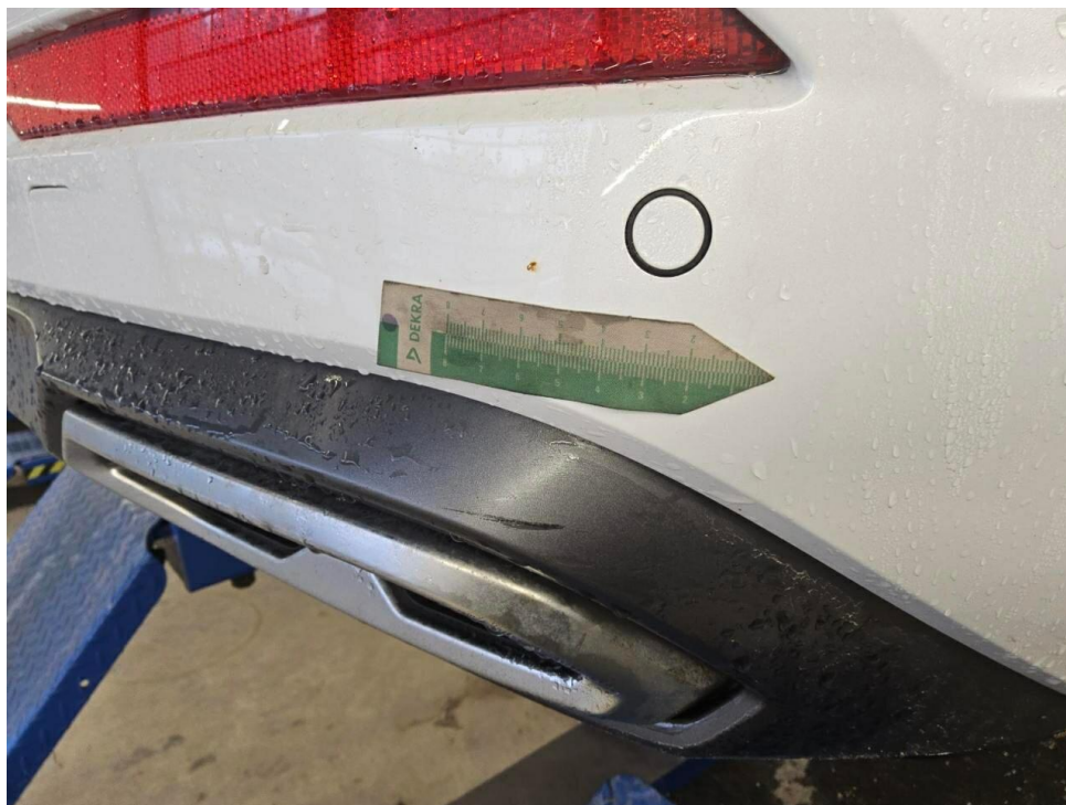
Bild 15 : Stoßfänger hinten Lackierung, zerkratzt, Gebrauchsspur
