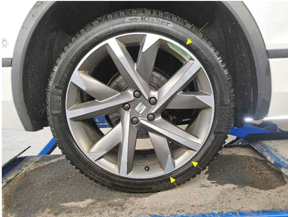
Bild 27 : LM Felge hinten rechts glanzgedreht verschrammt
