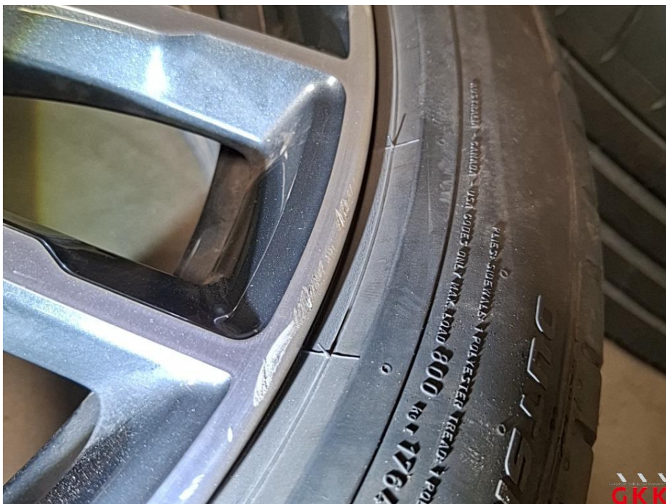
Bild 33 LM-Rad, 2 x beiliegend, beschädigt, ersetzen
