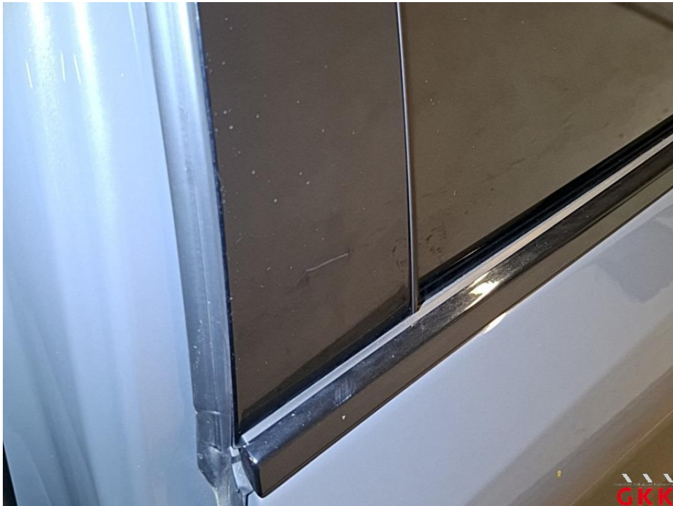
Bild 31 Tür vorne links, Blende -Fensterrahmen-, verkratzt, ersetzen
