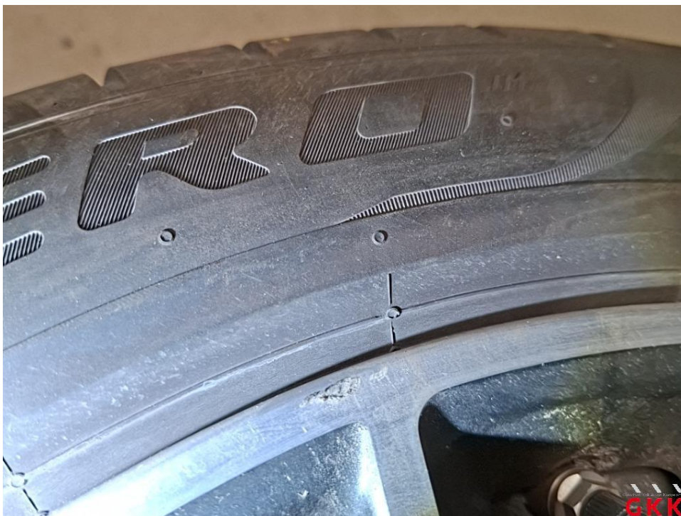
Bild 34 LM-Rad, 2 x beiliegend, beschädigt, ersetzen
