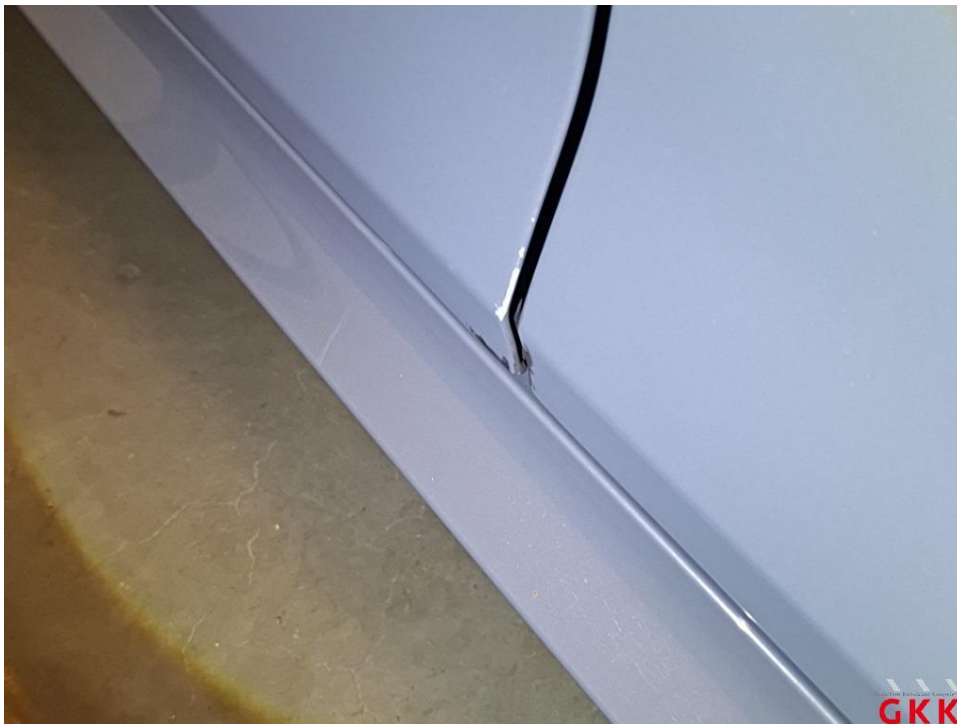
Bild 38 Tür vorne links, Kante, beschädigt, Smartrepair
