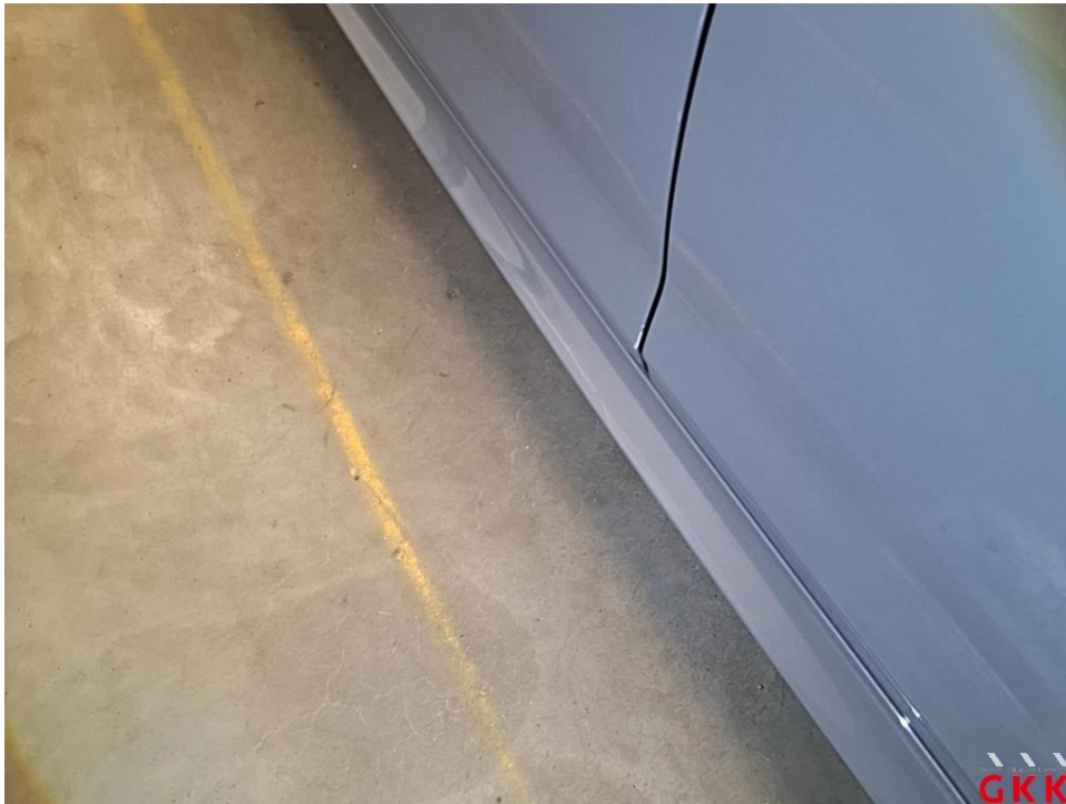
Bild 37 Tür vorne links, Kante, beschädigt, Smartrepair
