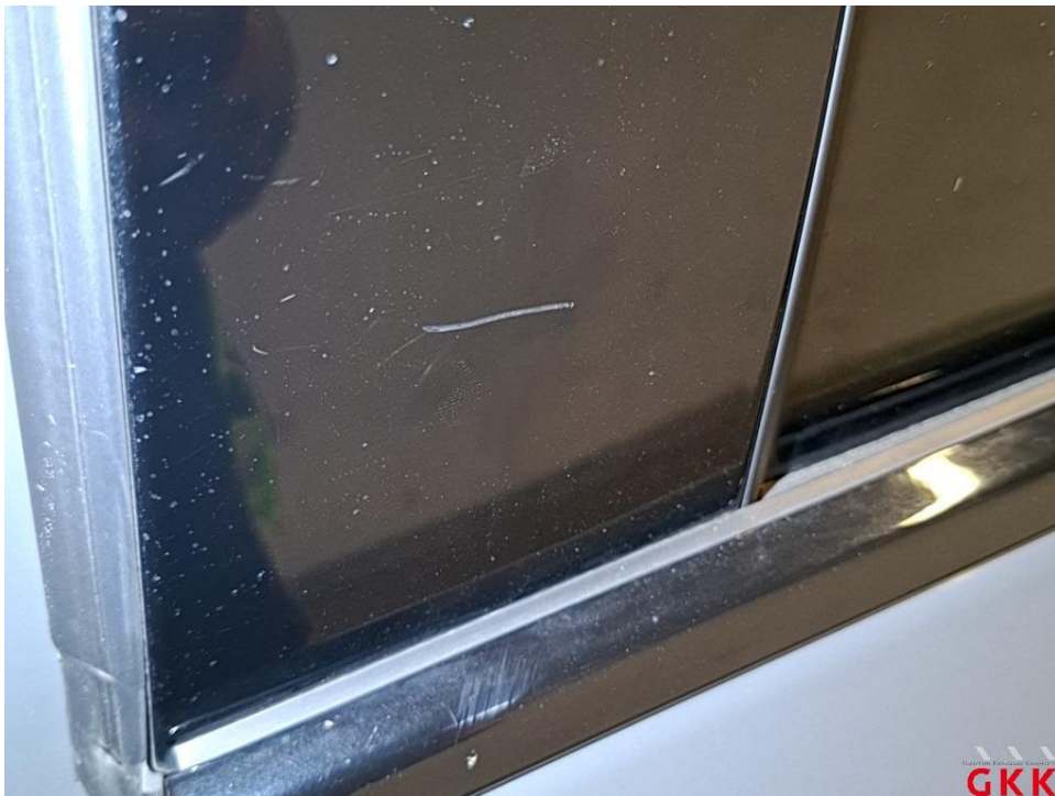
Bild 32 Tür vorne links, Blende -Fensterrahmen-, verkratzt, ersetzen
