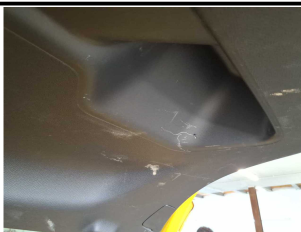
Beschädigung #6: Verkleidungen/Abdeckungen: Kofferraumverkleidung - verkratzt / verschürft - Wertminderung
