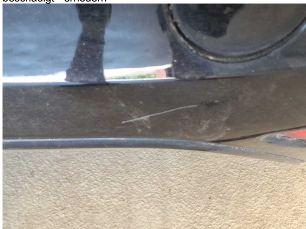
Beschädigung #2: Stossfänger hinten: Spoiler - verkratzt / verschürft - Wertminderung
