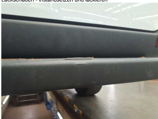
Beschädigung #7: Stossfänger hinten: Verkl. Stossfänger Auftritt mit Parktronic - gebrochen / gerissen - erneuern
