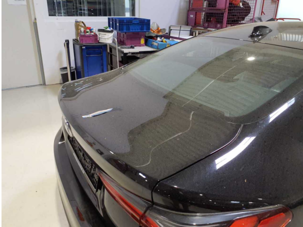
Beschädigung #3: Heckklappe/-tür: Heckklappe - verkratzt / verschürft - lackieren
