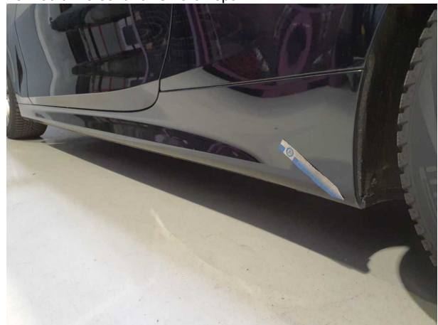
Beschädigung #2: Schweller links: Verkleidung - verkratzt / verschürft - Smart Repair
