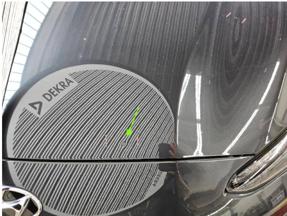
Bild 11 : Motorhaube, eingedellt, instandsetzen und lackieren mit Lackaufbau
