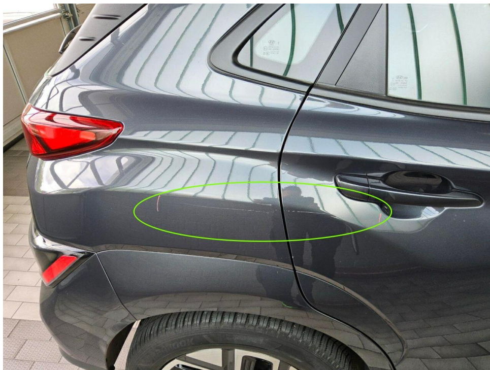
Bild 7 : Tür hinten rechts Lackierung, verschrammt, lackieren mit Lackaufbau Seitenteil hinten rechts Lackierung, verschrammt, lackieren mit Lackaufbau
