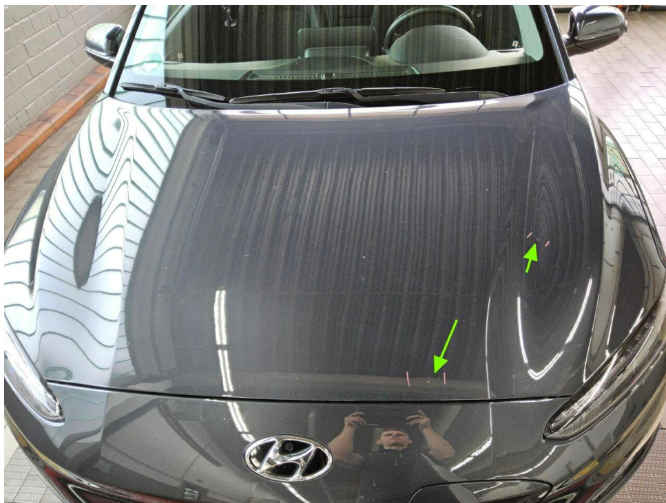
Bild 10 : Motorhaube, eingedellt, instandsetzen und lackieren mit Lackaufbau
