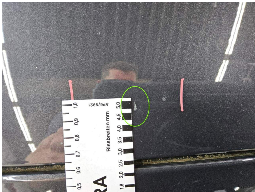
Bild 12 : Motorhaube, eingedellt, instandsetzen und lackieren mit Lackaufbau
