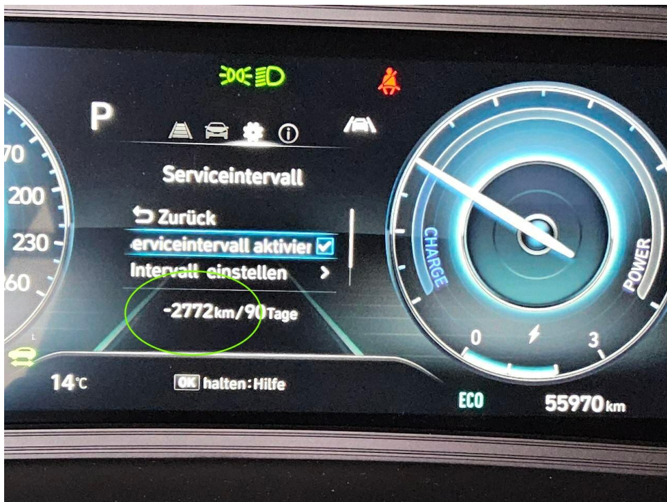
Bild 14 : Wartung fällig seit 2772km
