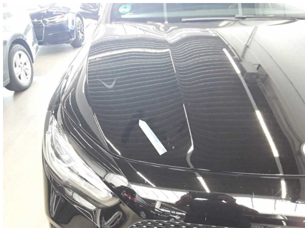
Beschädigung #1: Motorhaube: Motorhaube - Steinschlag - lackieren
