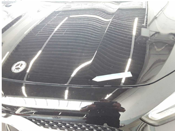
Beschädigung #1: Motorhaube: Motorhaube - Steinschlag - lackieren
