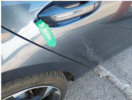
Puerta / Trasero Derecho / Abolladura
