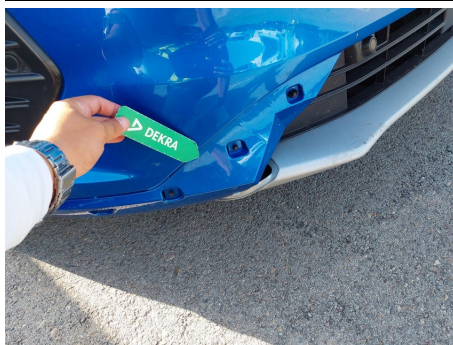
Spoiler / Delantero Derecho / Faltante
