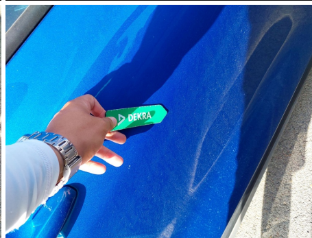
Puerta / Delantero Derecho / Abolladura
