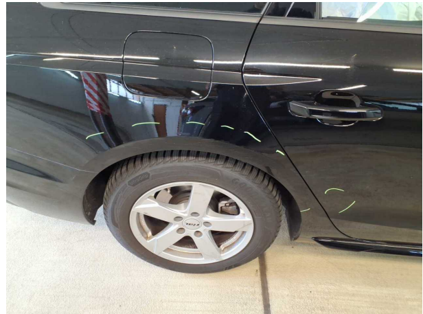
Beschädigung #7: Seitenwand rechts: Seitenwand - verkratzt / verschürft - instandsetzen und lackieren
