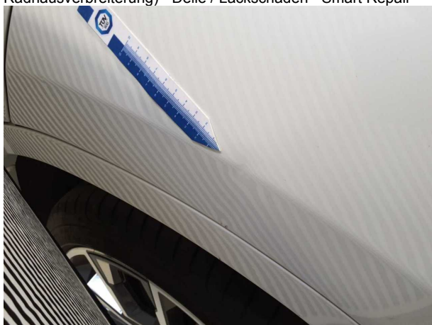
Beschädigung #6: Seitenwand links: Seitenwand (An Kante inkl. Radhausverbreiterung) - Delle / Lackschaden - Smart Repair
