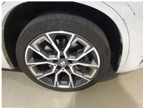
Beschädigung #2: Vorderachse: Vorderachse (Reifen VR einseitig abgefahren) - Fehlstellung - einstellen/justieren
