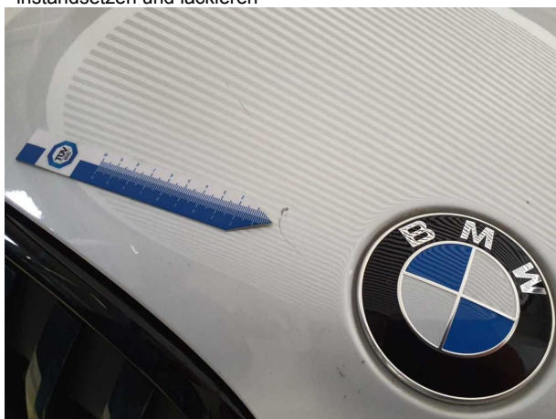
Beschädigung #9: Motorhaube: Motorhaube - Delle / Lackschad... - instandsetzen und lackieren
