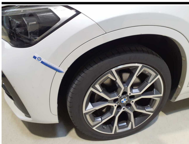
Beschädigung #5: Kotflügel links: Radhausverbreiterung - verkratzt / verschürft - Smart Repair
