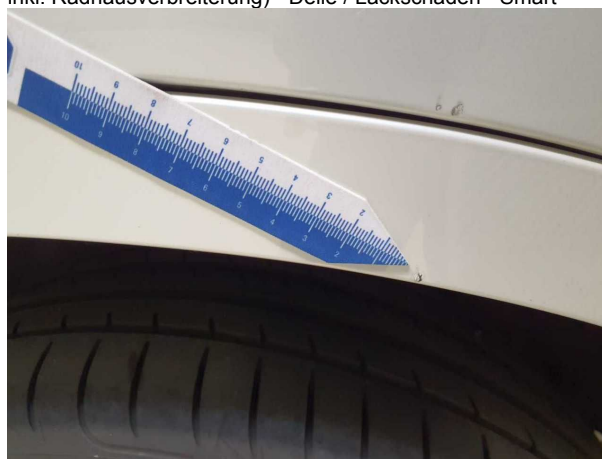
Beschädigung #6: Seitenwand links: Seitenwand (An Kante inkl. Radhausverbreiterung) - Delle / Lackschaden - Smart
