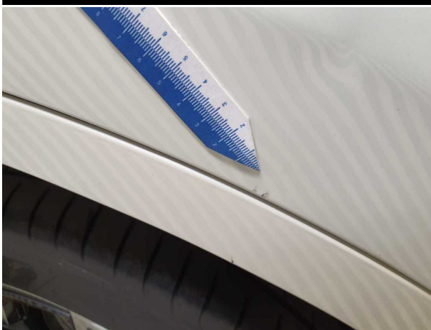
Beschädigung #6: Seitenwand links: Seitenwand (An Kante inkl. Radhausverbreiterung) - Delle / Lackschaden - Smart Repair
