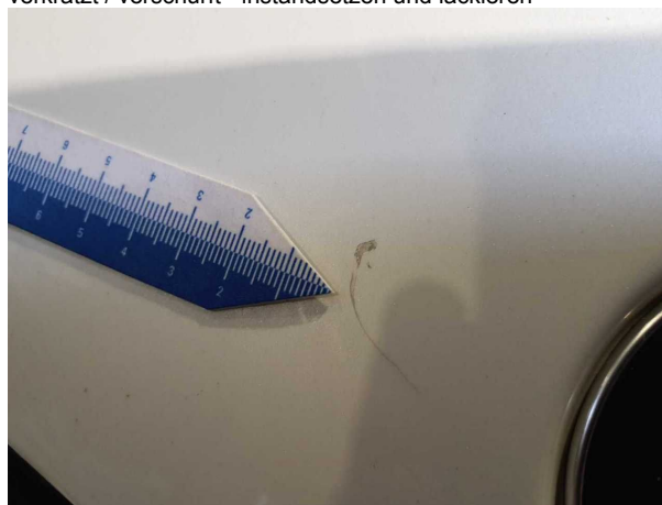
Beschädigung #9: Motorhaube: Motorhaube - Delle / Lackschaden - instandsetzen und lackieren
