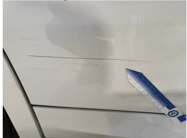
Beschädigung #7: Tür hinten rechts: Tür (inklusive Radhausverbreiterung) - verkratzt / verschürft - lackieren
