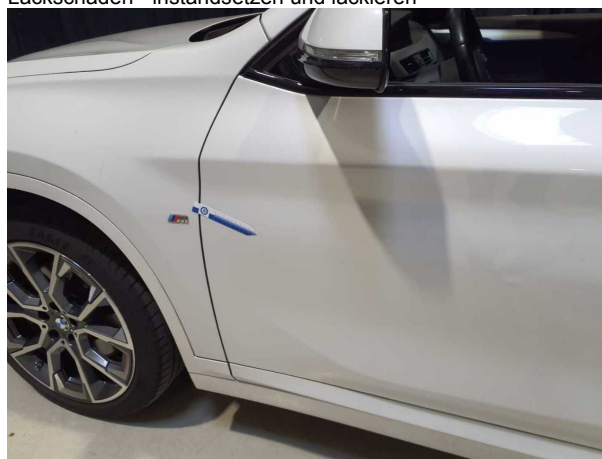
Beschädigung #10: Tür vorn links: Tür - Delle / Lackschaden - instandsetzen und lackieren
