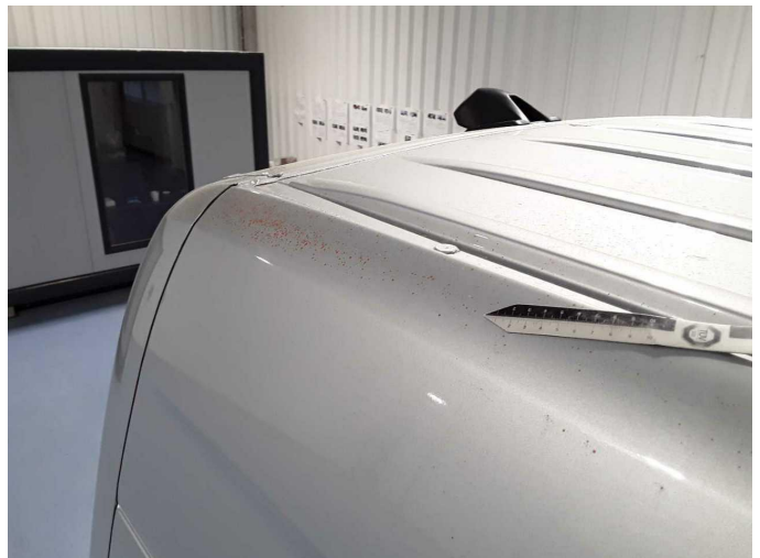
Beschädigung 41: Fahrzeugdach: Dachholm rechts - verschmutzt - lackieren
