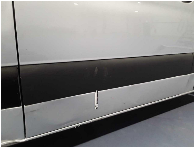
Beschädigung 15: Schiebetür rechts: Schutzleiste - beschädigt - erneuern
