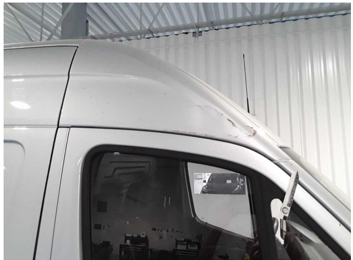
Beschädigung 38: Fahrzeugdach: Dachholm rechts - verkratzt / verschürft - instandsetzen/lackieren (S3)
