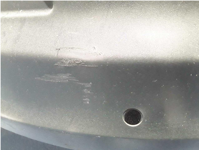
Beschädigung 35: Stossfänger vorn: Stossfänger vorn (unlackiert) - verformt - instandsetzen/lackieren (S3)
