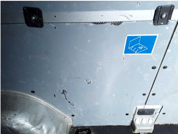
Beschädigung 3: Verkleidungen/Abdeckungen: Laderaumverkleidung links - beschädigt - erneuern
