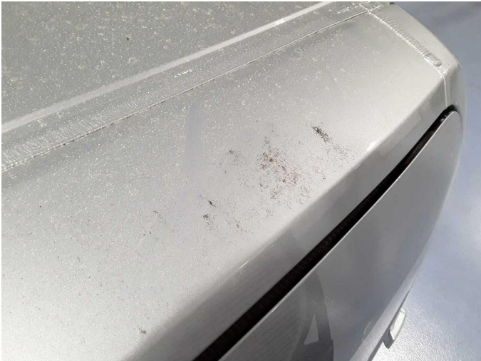
Beschädigung 42: Koffer: Dachabschlußprofil - verschmutzt - lackieren
