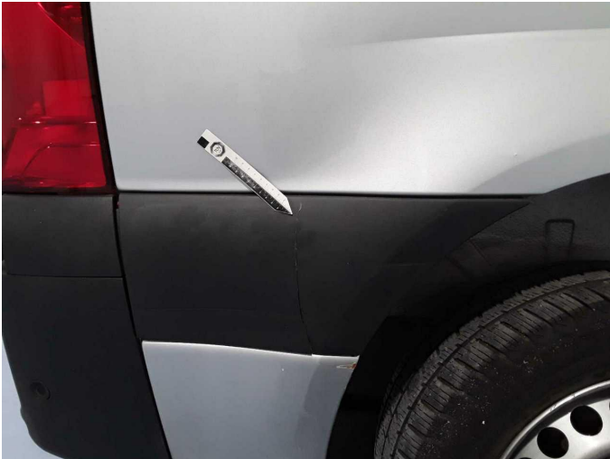
Beschädigung 18: Seitenwand rechts: Schutzleiste - beschädigt - erneuern
