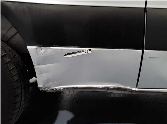
Beschädigung 13: Schweller rechts: Schweller - beschädigt - erneuern
