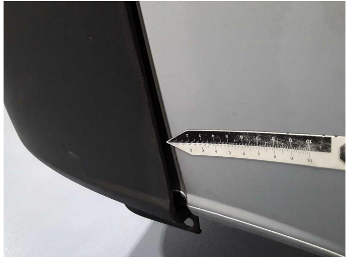
Beschädigung 19: Stossfänger hinten: Schutzleiste rechts - beschädigt - erneuern
