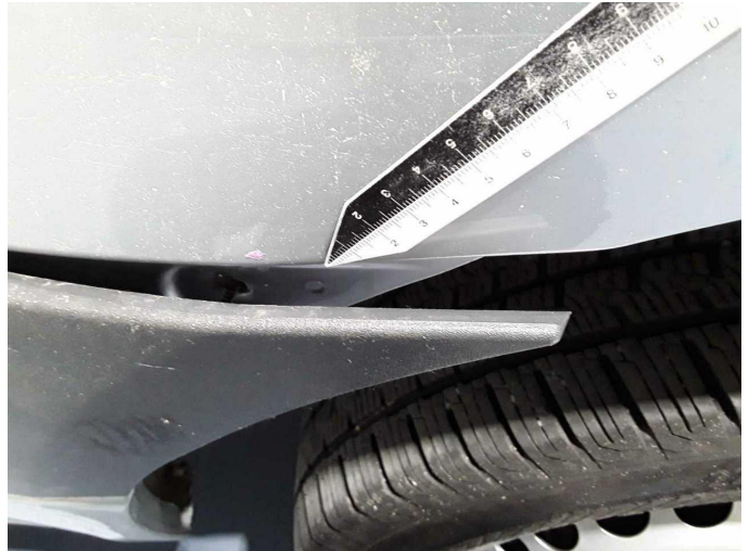
Beschädigung 31: Seitenwand links: Schutzleiste - beschädigt - erneuern
