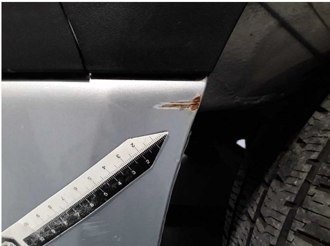
Beschädigung 20: Seitenwand rechts: Radlauf - Korrosion - instandsetzen/lackieren (S3)
