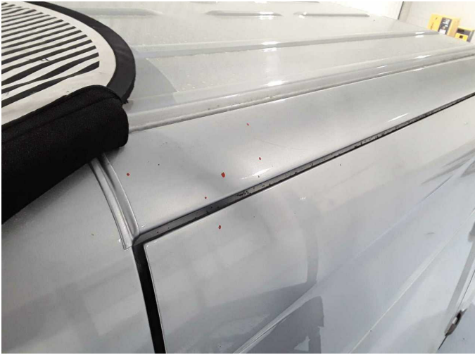
Beschädigung 41: Fahrzeugdach: Dachholm rechts - verschmutzt - lackieren
