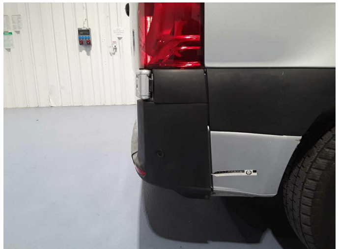
Beschädigung 19: Stossfänger hinten: Schutzleiste rechts - beschädigt - erneuern
