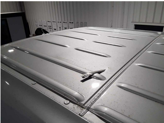
Beschädigung 40: Fahrzeugdach: Dach - Korrosion - instandsetzen/ lackieren (S3)
