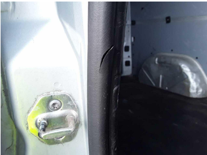
Beschädigung 7: Heckklappe/-tür: Dichtung - beschädigt - erneuern
