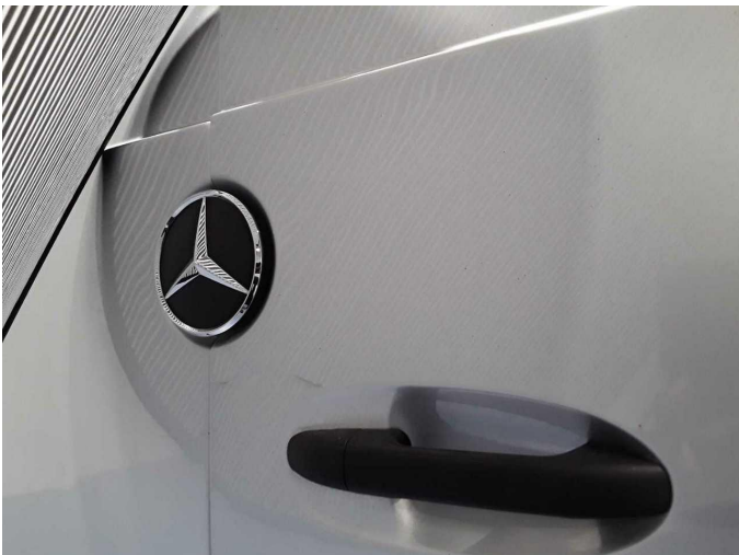
Beschädigung 23: Heckklappe/-tür: Hecktür rechts - verformt - instandsetzen/lackieren (S3)
