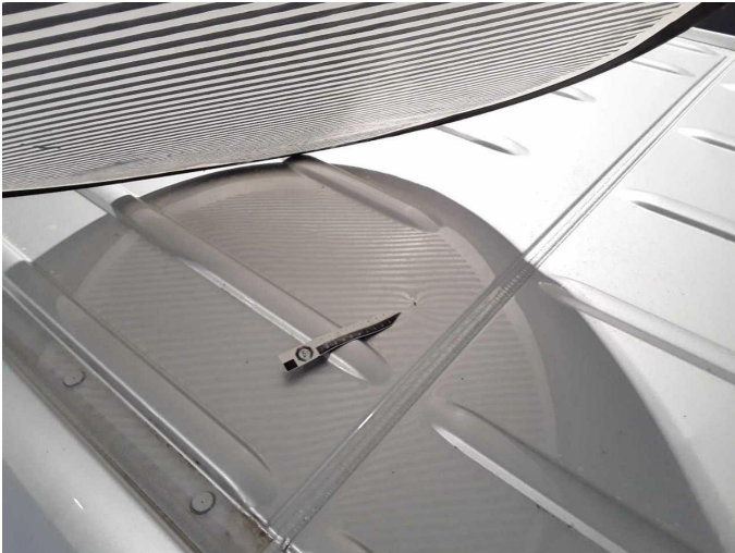
Beschädigung 40: Fahrzeugdach: Dach - Korrosion - instandsetzen/ lackieren (S3)
