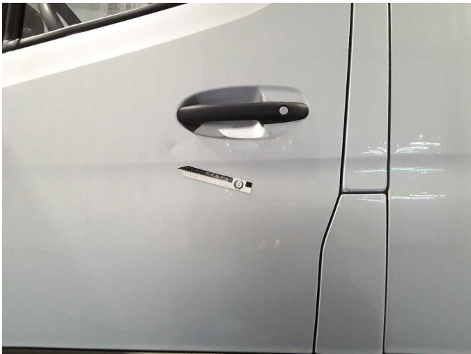
Beschädigung 33: Tür vorn links: Tür - Delle / Lackschaden - instandsetzen/lackieren (S3)
