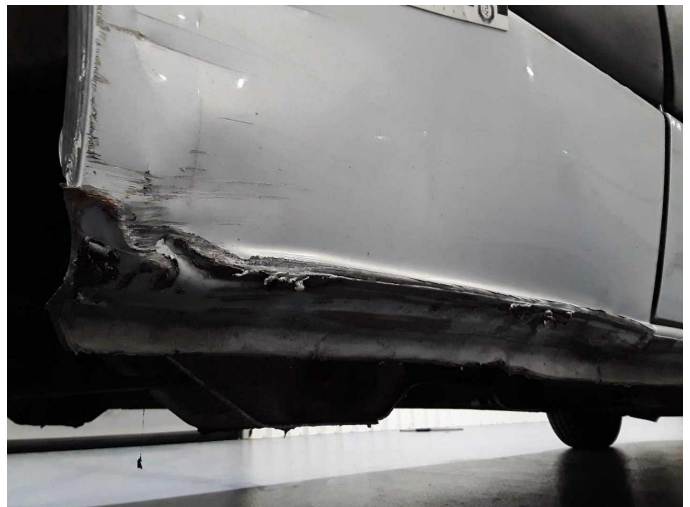
Beschädigung 13: Schweller rechts: Schweller - beschädigt - erneuern
