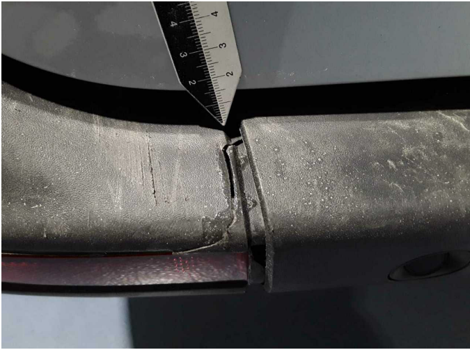
Beschädigung 25: Stossfänger hinten: Schutzleiste links - gebrochen / gerissen - erneuern
