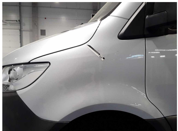
Beschädigung 34: Kotflügel links: Kotflügel links - Delle / Lackschaden - instandsetzen/lackieren (S3)
