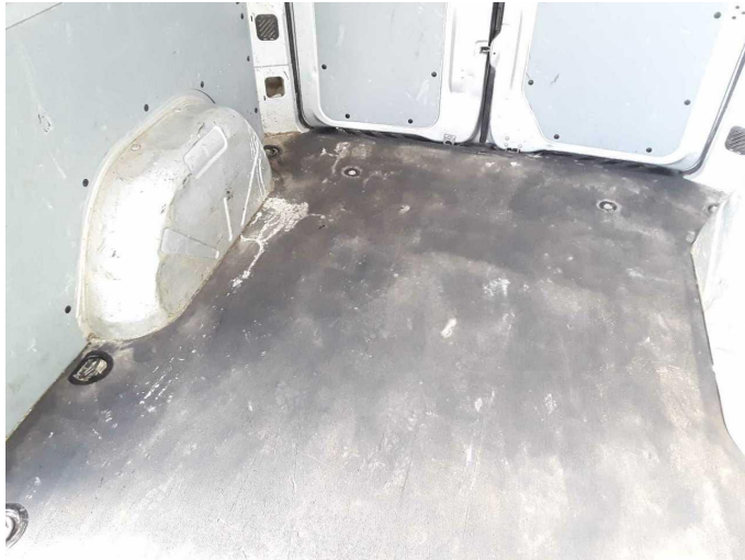
Beschädigung 8: Interieur: Laderaumboden - beschädigt - instandsetzen
