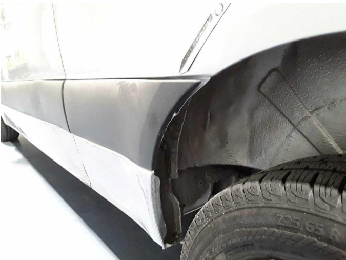
Beschädigung 31: Seitenwand links: Schutzleiste - beschädigt - erneuern
