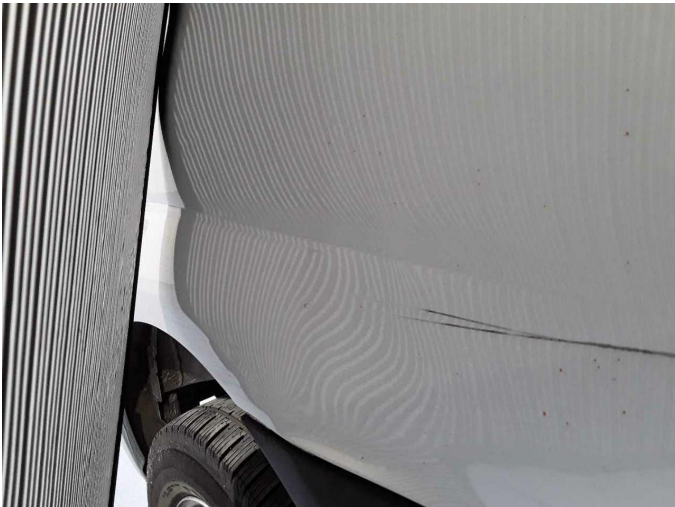
Beschädigung 14: Seitenwand rechts: Seitenwand - verformt - instandsetzen/lackieren (S3)
