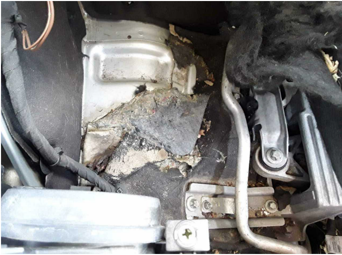
Beschädigung 2: Motor: Motorverkleidung - beschädigt - erneuern
