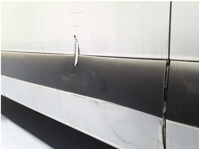
Beschädigung 32: Seitenwand links: Schutzleiste - gebrochen / gerissen - erneuern
