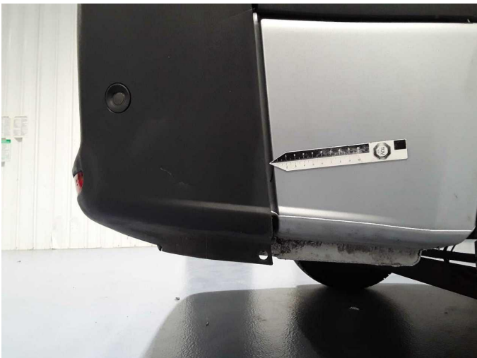
Beschädigung 19: Stossfänger hinten: Schutzleiste rechts - beschädigt - erneuern
