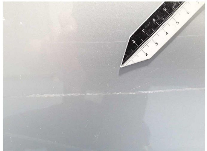
Beschädigung 28: Seitenwand links: Seitenwand - Delle / Lackschaden - instandsetzen/lackieren (S3)
