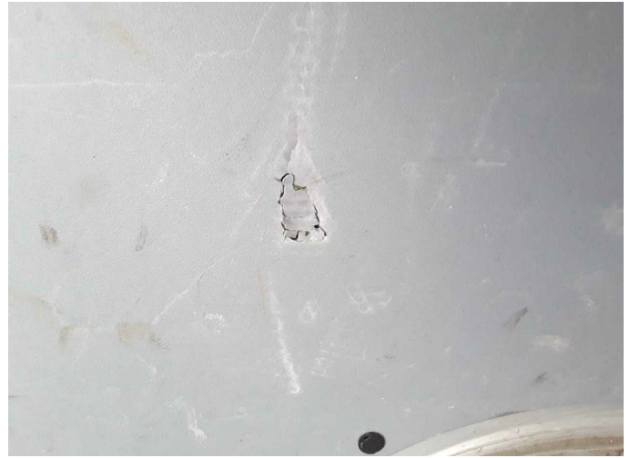
Beschädigung 4: Verkleidungen/Abdeckungen: Laderaumverkleidung rechts - beschädigt - erneuern
