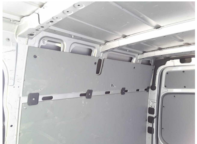
Beschädigung 4: Verkleidungen/Abdeckungen: Laderaumverkleidung rechts - beschädigt - erneuern
