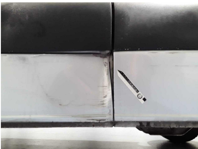
Beschädigung 29: Schweller links: Schweller - verformt - erneuern
