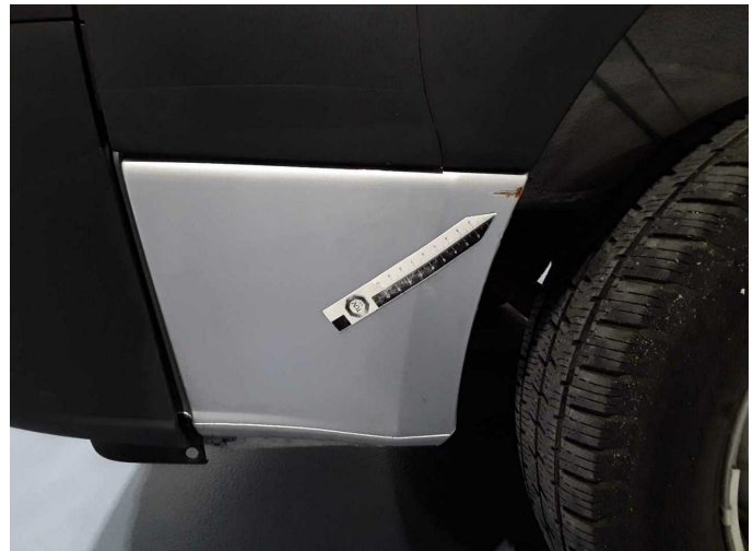
Beschädigung 20: Seitenwand rechts: Radlauf - Korrosion - instandsetzen/lackieren (S3)
