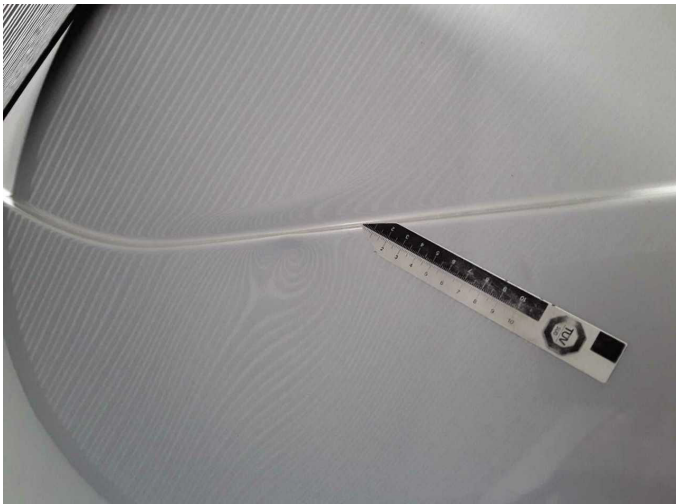
Beschädigung 24: Heckklappe/-tür: Hecktür links - verformt - erneuern
