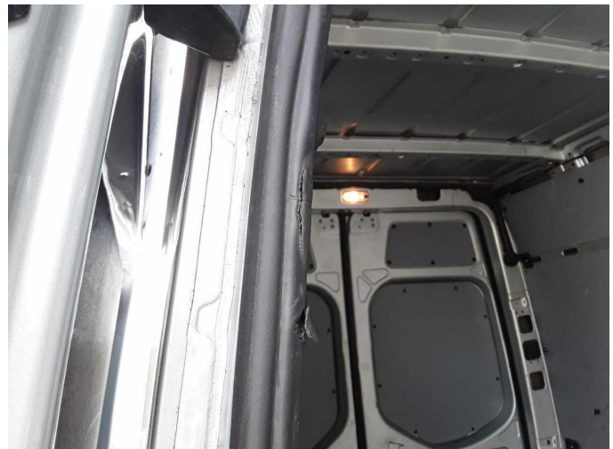
Beschädigung 7: Heckklappe/-tür: Dichtung - beschädigt - erneuern
