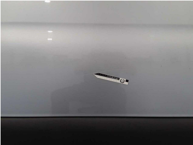
Beschädigung 12: Schiebetür rechts: Schiebetür - Delle / Lackschaden - instandsetzen/lackieren (S3)
