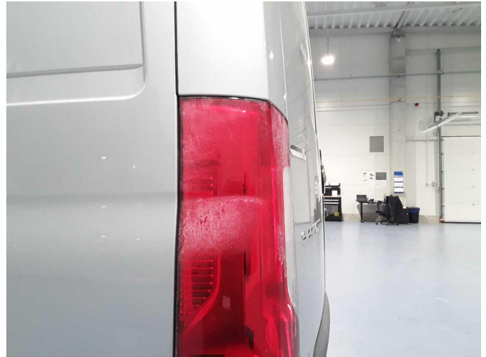
Beschädigung 26: Heckleuchte: Heckleuchte links (Schadenserweiterung möglich) - verschmutzt - reinigen
