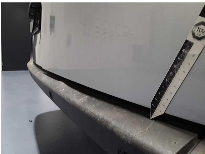
Beschädigung 22: Stossfänger hinten: Stossfänger hinten (unlackiert) - verformt - erneuern
