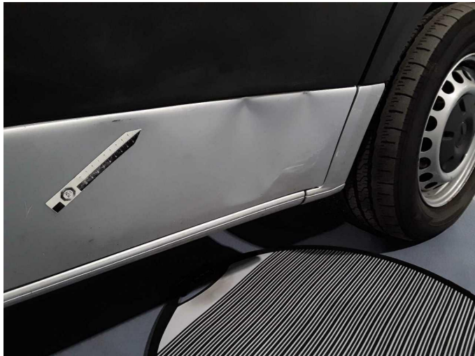
Beschädigung 9: Tür vorn rechts: Tür - verformt - erneuern
