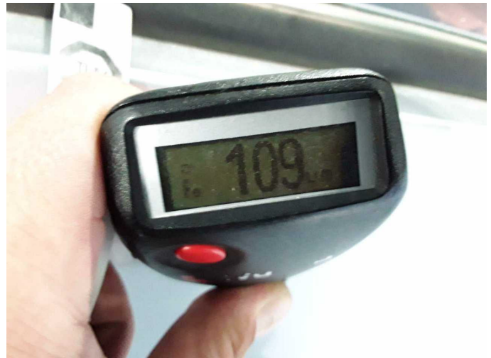
Tür vorne rechts: 109 \mu\text{m}
