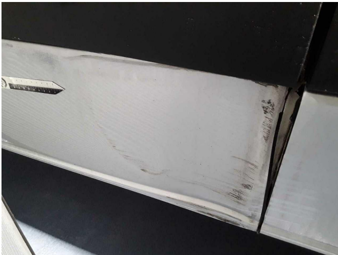
Beschädigung 29: Schweller links: Schweller - verformt - erneuern
