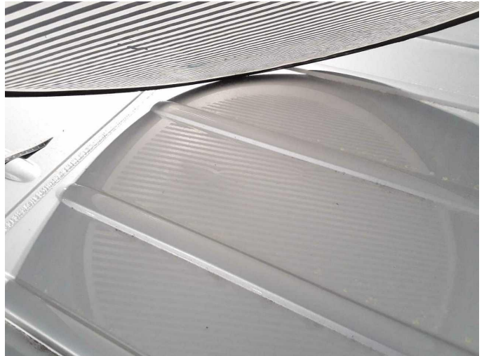
Beschädigung 40: Fahrzeugdach: Dach - Korrosion - instandsetzen/ lackieren (S3)
