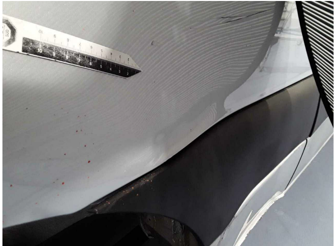
Beschädigung 14: Seitenwand rechts: Seitenwand - verformt - instandsetzen/lackieren (S3)
