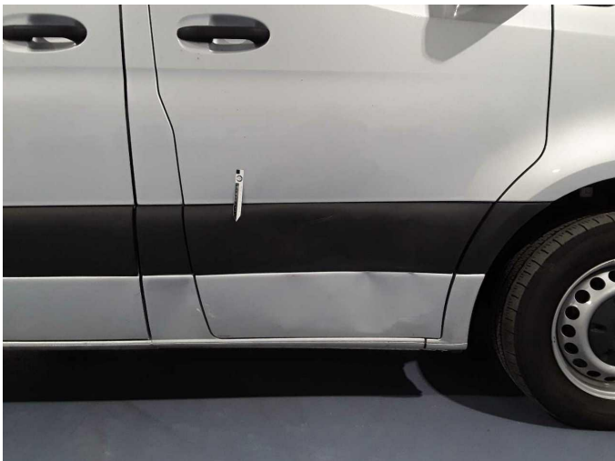
Beschädigung 11: Tür vorn rechts: Zierleiste oben - verformt - erneuern
