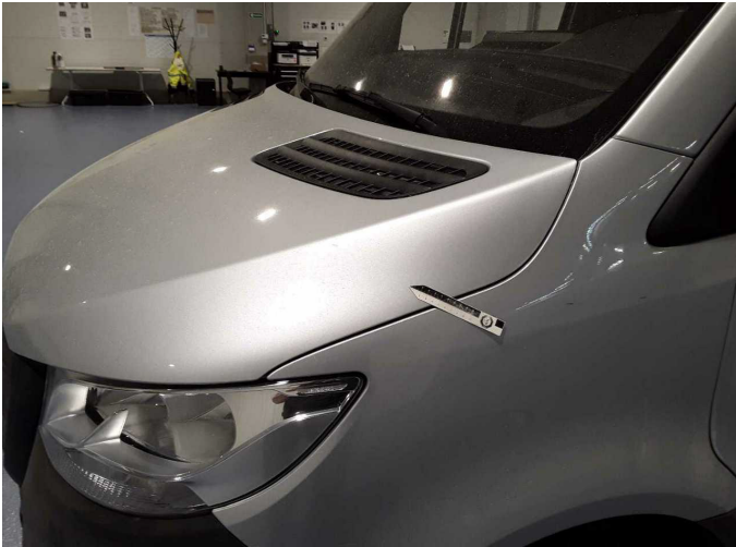
Beschädigung 36: Motorhaube: Motorhaube - verkratzt / verschürft - instandsetzen/lackieren (S3)
