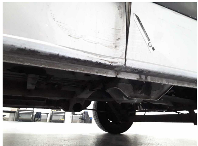
Beschädigung 29: Schweller links: Schweller - verformt - erneuern
