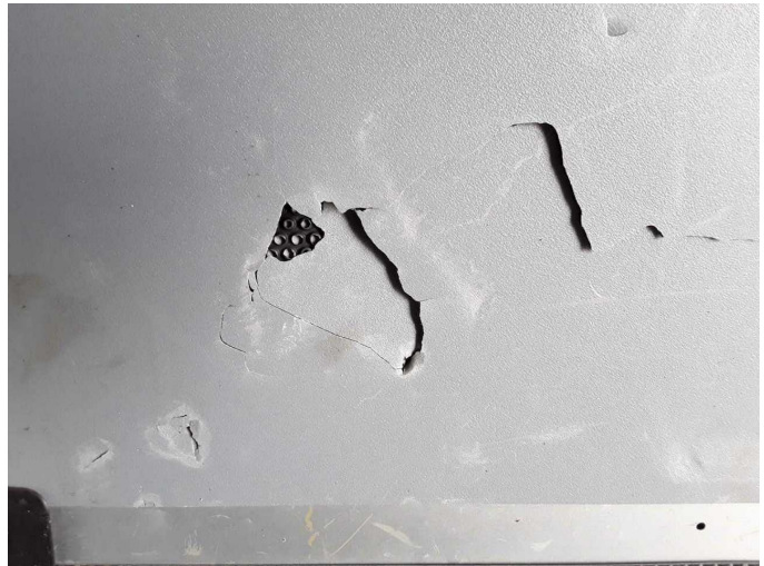
Beschädigung 3: Verkleidungen/Abdeckungen: Laderaumverkleidung links - beschädigt - erneuern
