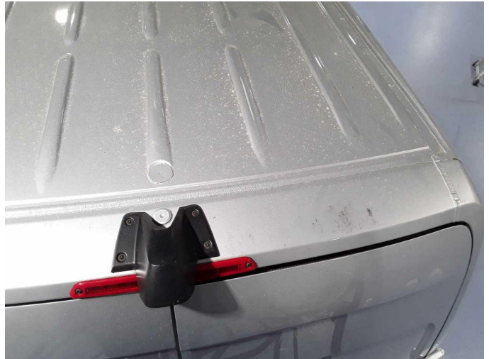
Beschädigung 42: Koffer: Dachabschlußprofil - verschmutzt - lackieren
