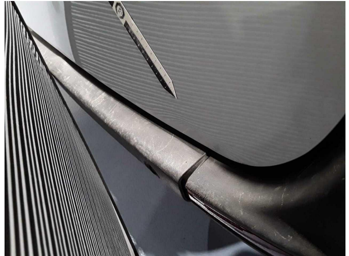
Beschädigung 23: Heckklappe/-tür: Hecktür rechts - verformt - instandsetzen/lackieren (S3)
