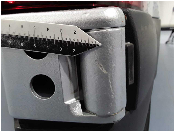
Beschädigung 21: Heckklappe/-tür: Scharnier unten - verkratzt / verschürft - lackieren
