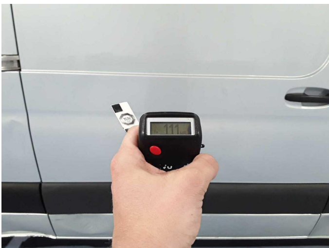
Tür hinten rechts: 111 \mu\text{m}
