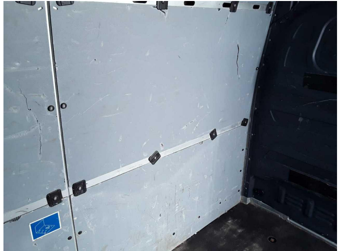
Beschädigung 3: Verkleidungen/Abdeckungen: Laderaumverkleidung links - beschädigt - erneuern
