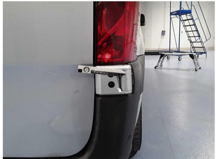
Beschädigung 21: Heckklappe/-tür: Scharnier unten - verkratzt / verschürft - lackieren
