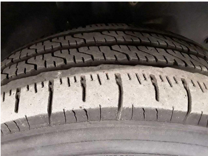
Beschädigung 43: Rad/Reifen: Reifen vorn rechts - verschlissen - erneuern
