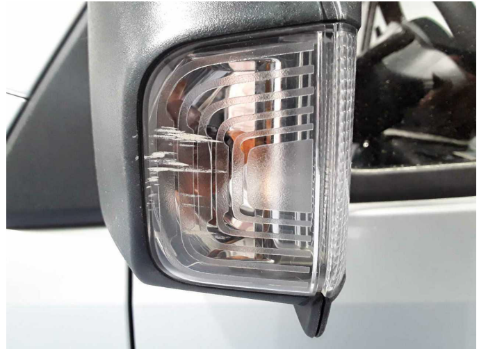
Beschädigung 45: Blinkleuchte: Spiegel links - verkratzt / verschürft - erneuern
