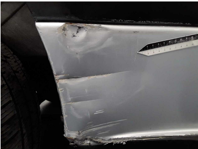
Beschädigung 13: Schweller rechts: Schweller - beschädigt - erneuern
