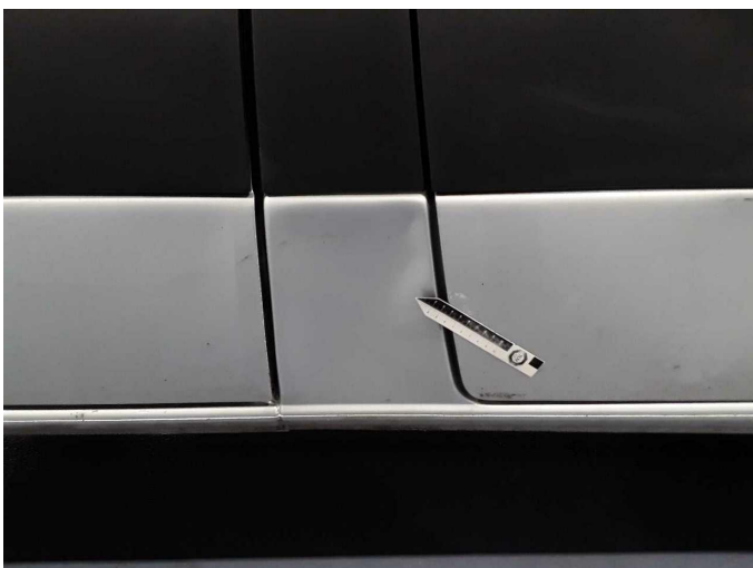
Beschädigung 16: Karosserie: B-Säule rechts - verformt - instandsetzen/lackieren (S3)
