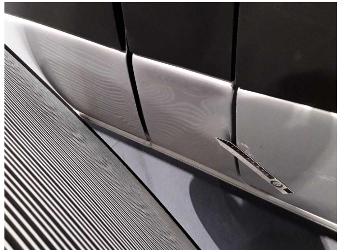
Beschädigung 16: Karosserie: B-Säule rechts - verformt - instandsetzen/lackieren (S3)
