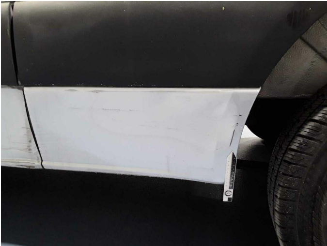
Beschädigung 30: Seitenwand links: Radlauf - verformt - instandsetzen/ lackieren (S3)
