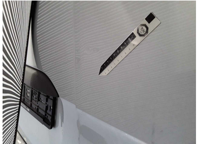
Beschädigung 23: Heckklappe/-tür: Hecktür rechts - verformt - instandsetzen/lackieren (S3)
