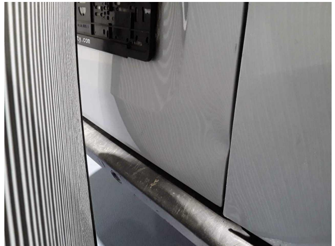
Beschädigung 24: Heckklappe/-tür: Hecktür links - verformt - erneuern
