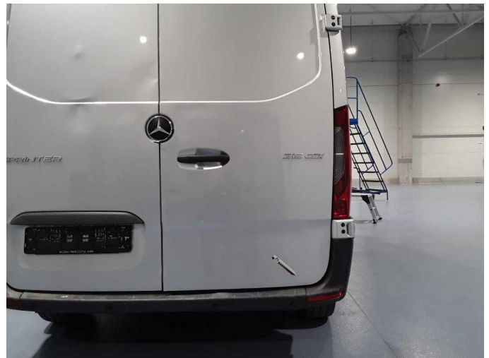
Beschädigung 23: Heckklappe/-tür: Hecktür rechts - verformt - instandsetzen/lackieren (S3)
