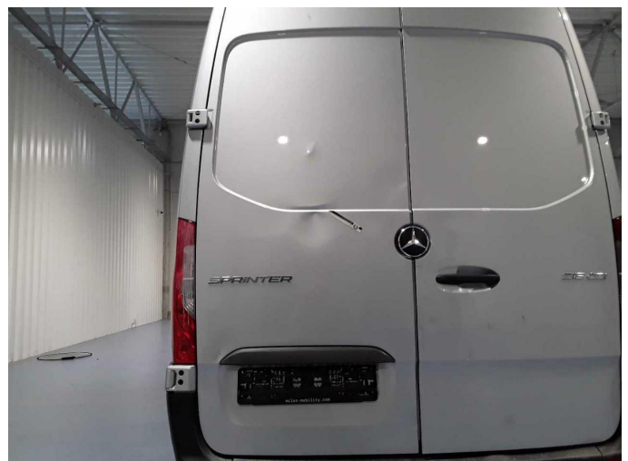
Beschädigung 24: Heckklappe/-tür: Hecktür links - verformt - erneuern
