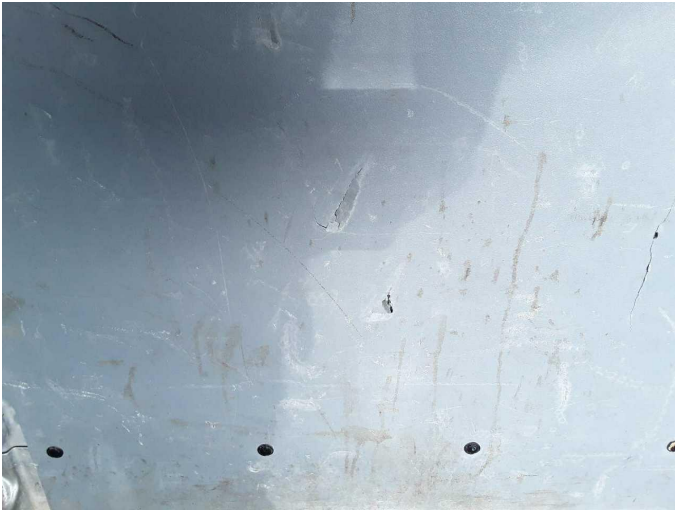
Beschädigung 3: Verkleidungen/Abdeckungen: Laderaumverkleidung links - beschädigt - erneuern
