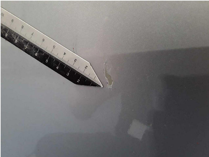
Beschädigung 23: Heckklappe/-tür: Hecktür rechts - verformt - instandsetzen/lackieren (S3)
