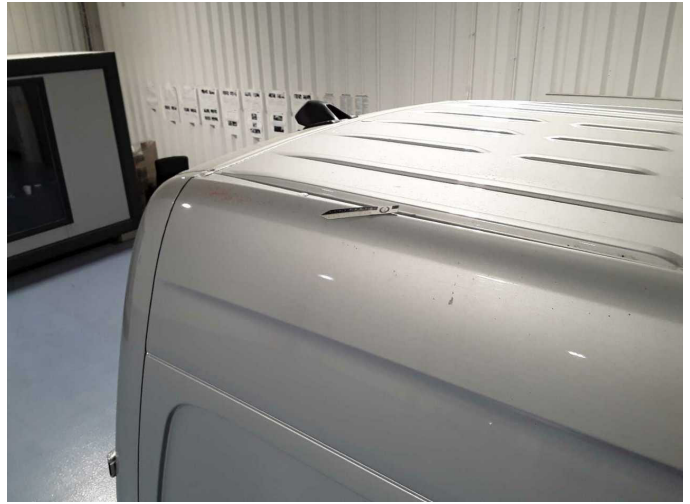
Beschädigung 41: Fahrzeugdach: Dachholm rechts - verschmutzt - lackieren
