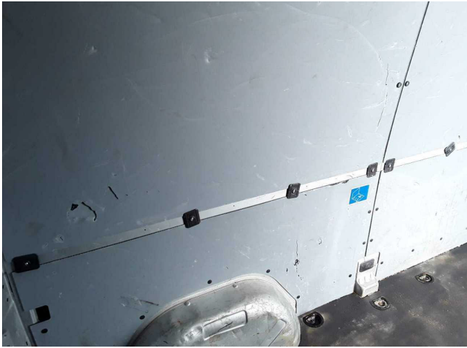
Beschädigung 3: Verkleidungen/Abdeckungen: Laderaumverkleidung links - beschädigt - erneuern
