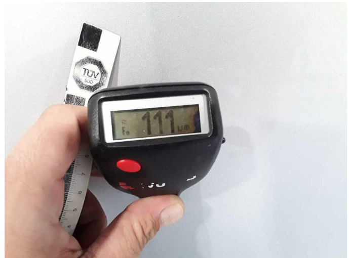
Tür hinten rechts: 111 \mu\text{m}
