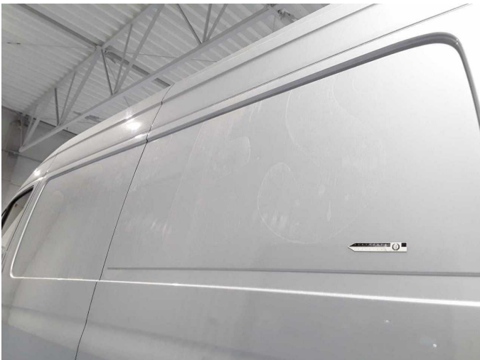
Beschädigung 27: Seitenwand links: Seitenwand - beklebt/ beschriftet - entkleben/neutralisieren
