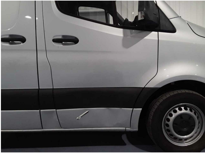
Beschädigung 9: Tür vorn rechts: Tür - verformt - erneuern
