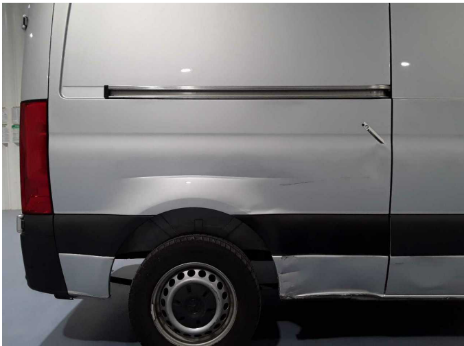
Beschädigung 14: Seitenwand rechts: Seitenwand - verformt - instandsetzen/lackieren (S3)
