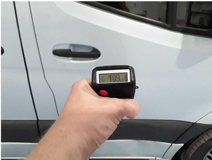
Tür vorne rechts: 109 \mu\text{m}
