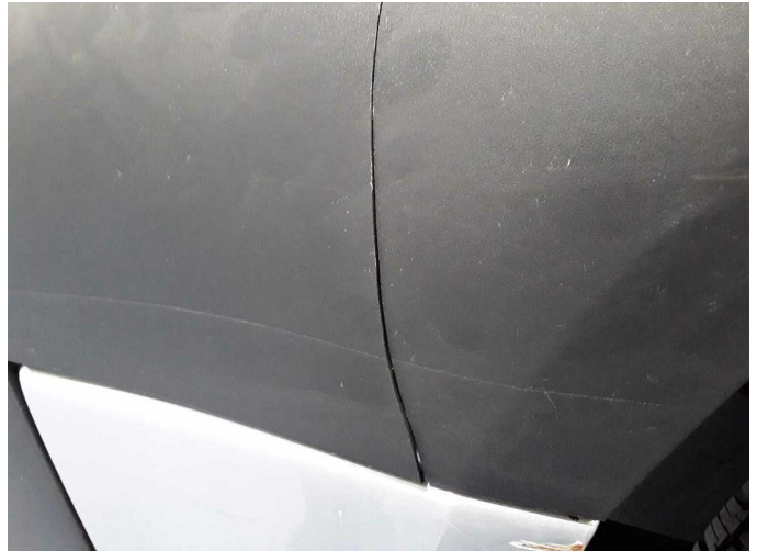
Beschädigung 18: Seitenwand rechts: Schutzleiste - beschädigt - erneuern
