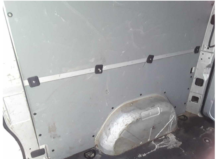
Beschädigung 4: Verkleidungen/Abdeckungen: Laderaumverkleidung rechts - beschädigt - erneuern
