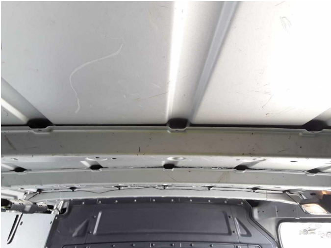
Beschädigung 6: Verkleidungen/Abdeckungen: Dachverkleidung Mitte - entspricht nicht den Herstellervorgaben - instandsetzen und lackieren
