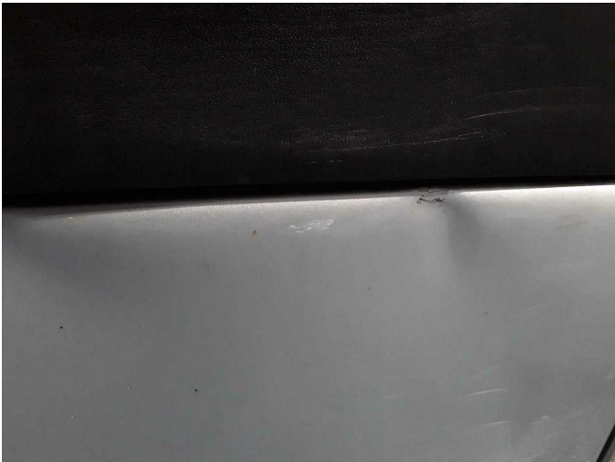
Beschädigung 9: Tür vorn rechts: Tür - verformt - erneuern
