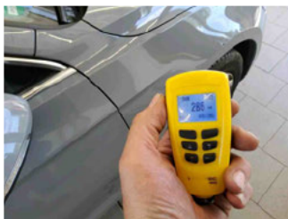
Lackstärke Kotflügel vorne rechts
