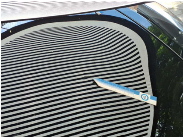
Beschädigung #3: Motorhaube: Motorhaube (6) - Delle(n) - sanft instandsetzen
