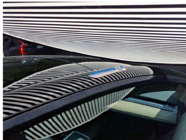
Beschädigung #1: Fahrzeugdach: Dachholm rechts - Delle(n) - sanft instandsetzen
