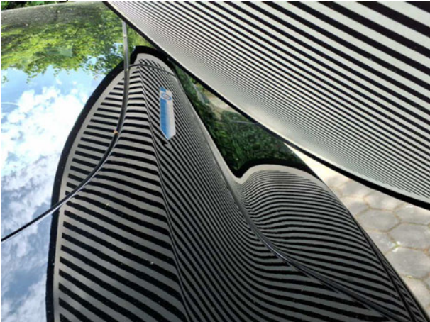
Beschädigung #7: Heckklappe/-tür: Heckklappe - Delle(n) - sanft instandsetzen
