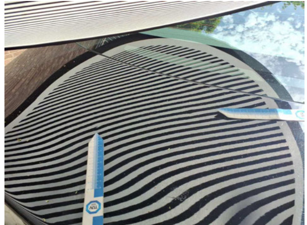
Beschädigung #7: Heckklappe/-tür: Heckklappe - Delle(n) - sanft instandsetzen
