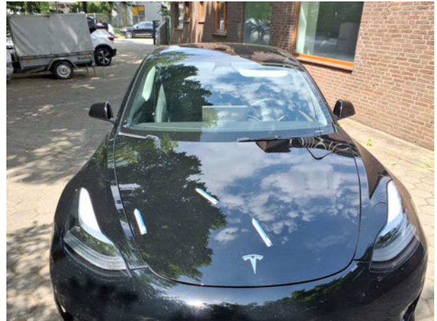
Beschädigung #3: Motorhaube: Motorhaube (6) - Delle(n) - sanft instandsetzen
