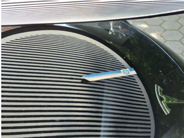
Beschädigung #3: Motorhaube: Motorhaube (6) - Delle(n) - sanft instandsetzen
