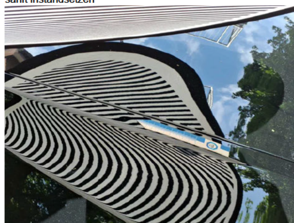
Beschädigung #2: Kotflügel rechts: Kotflügel rechts - Delle(n) - sanft instandsetzen
