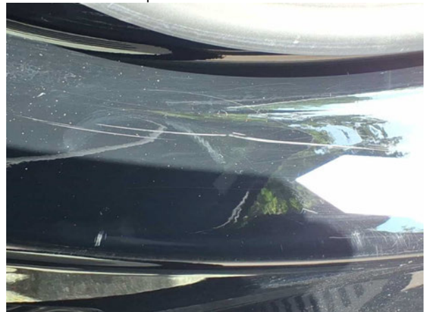
Beschädigung #5: Schweller rechts: Einstieg - verkratzt / verschürft - Smart Repair
