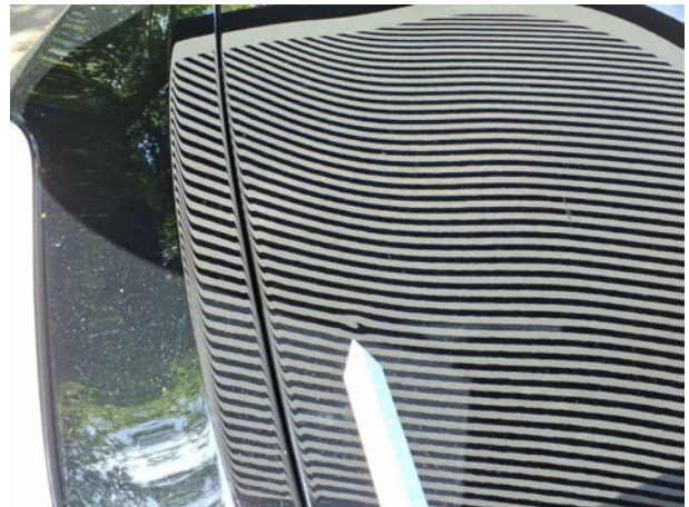
Beschädigung #3: Motorhaube: Motorhaube (6) - Delle(n) - sanft instandsetzen
