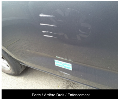
Porte / Arrière Droit / Enfoncement
