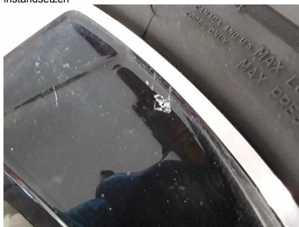
Beschädigung #3: 2.Radsatz: 1 Leichtmetallfelge - verkratzt / verschürft - Wertminderung
