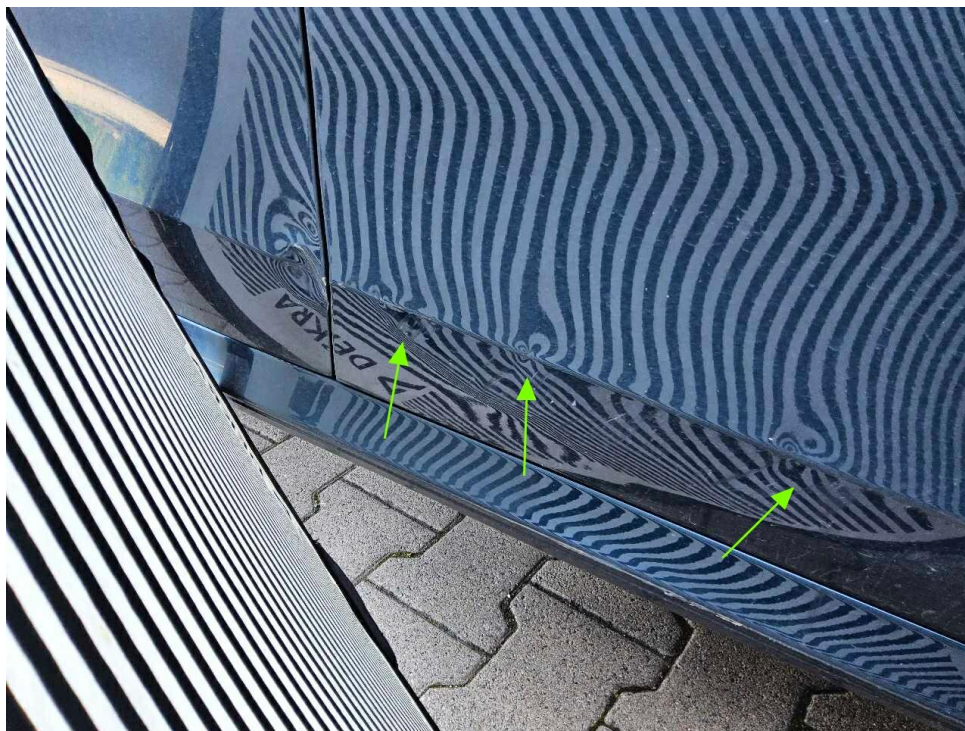
Bild 14 : Tür vorne rechts, verschrammt/ingedellt
