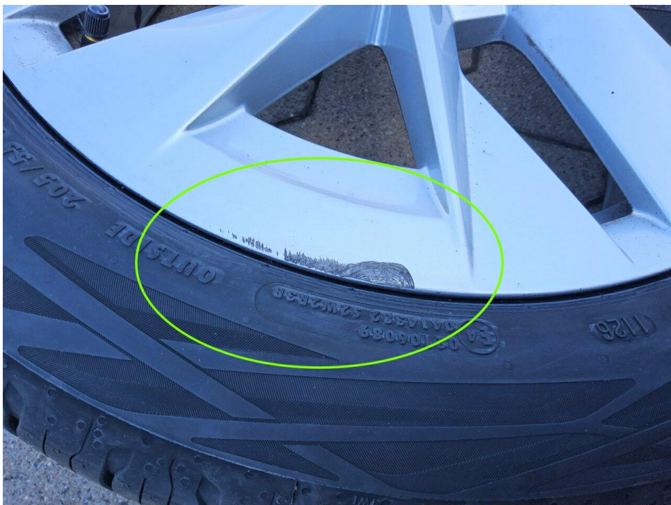
Bild 16 : Alufelge vorne rechts, verschrammt
