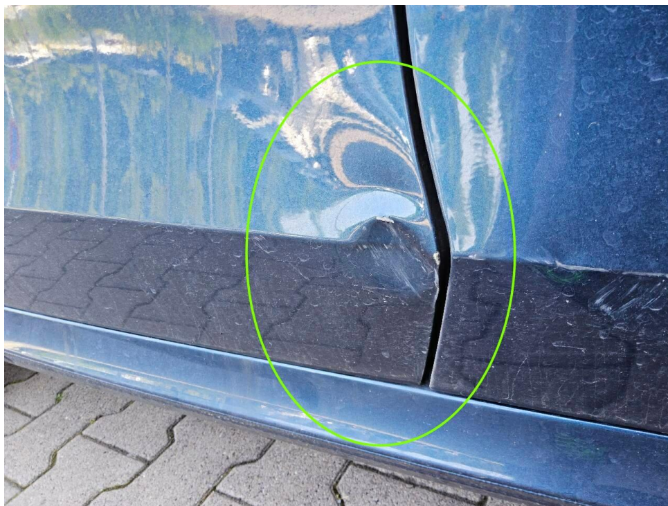
Bild 12 : Tür hinten rechts, verformt/verschrammt
