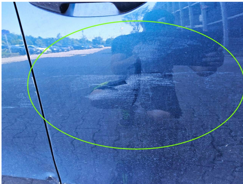
Bild 13 : Tür vorne rechts, verschrammt/ingedellt
