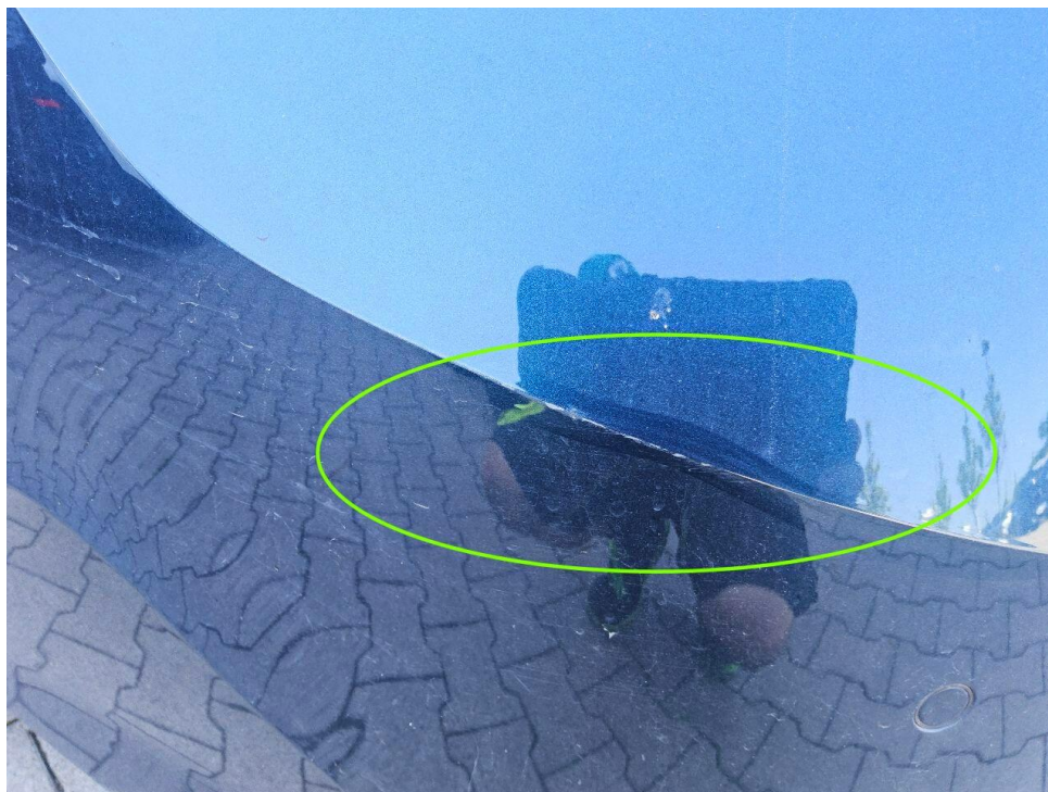
Bild 7 : Stoßfänger hinten, verschrammt
